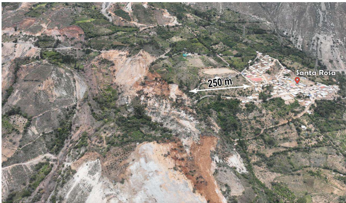
Figura 8. Inicio del deslizamiento con un escarpe principal de forma irregular y continua. En su flanco izquierdo se muestra la población de Santa Rosa a 250 m de distancia.
