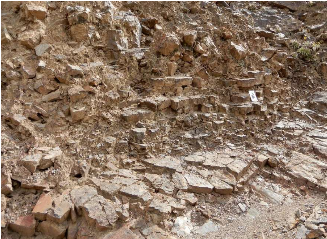
Fotografía 2. Afloramiento de areniscas fragmentadas ubicado debajo de los depósitos coluvio-deluviales. Coordenadas UTM: 180734 / 9032592, Zona 18.
