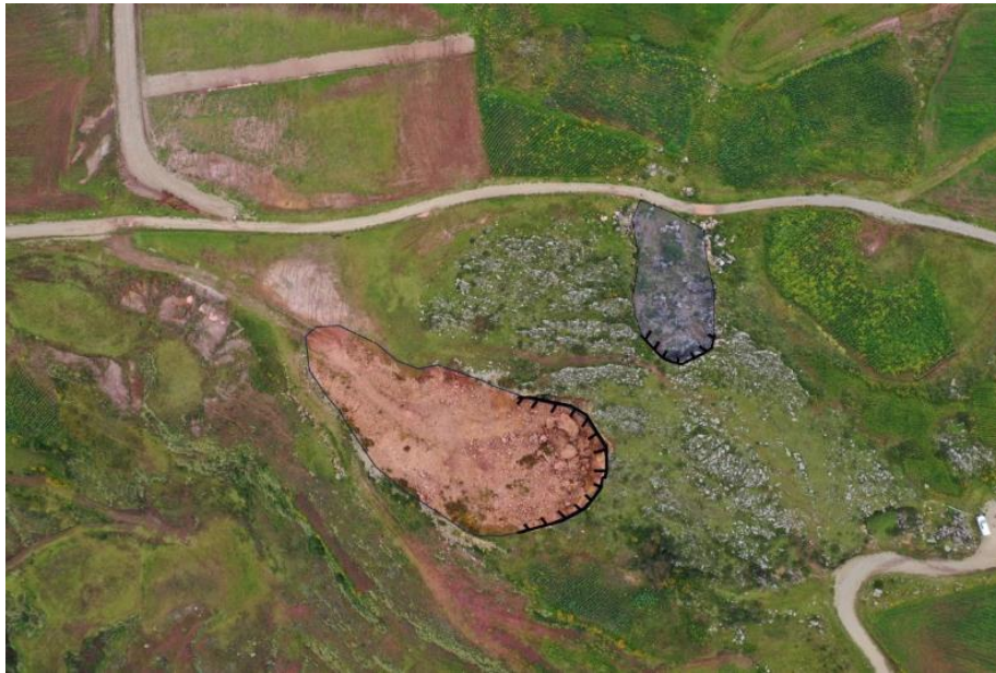
Figura 13: El derrumbe B se muestra en el polígono color rojo, con corona de 54 m y con presencia de nuevas activaciones.
