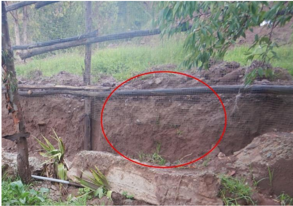
Figura 7. Depósito coluvio-deluvial compuesto Gravas en matriz arcillolimoso.
