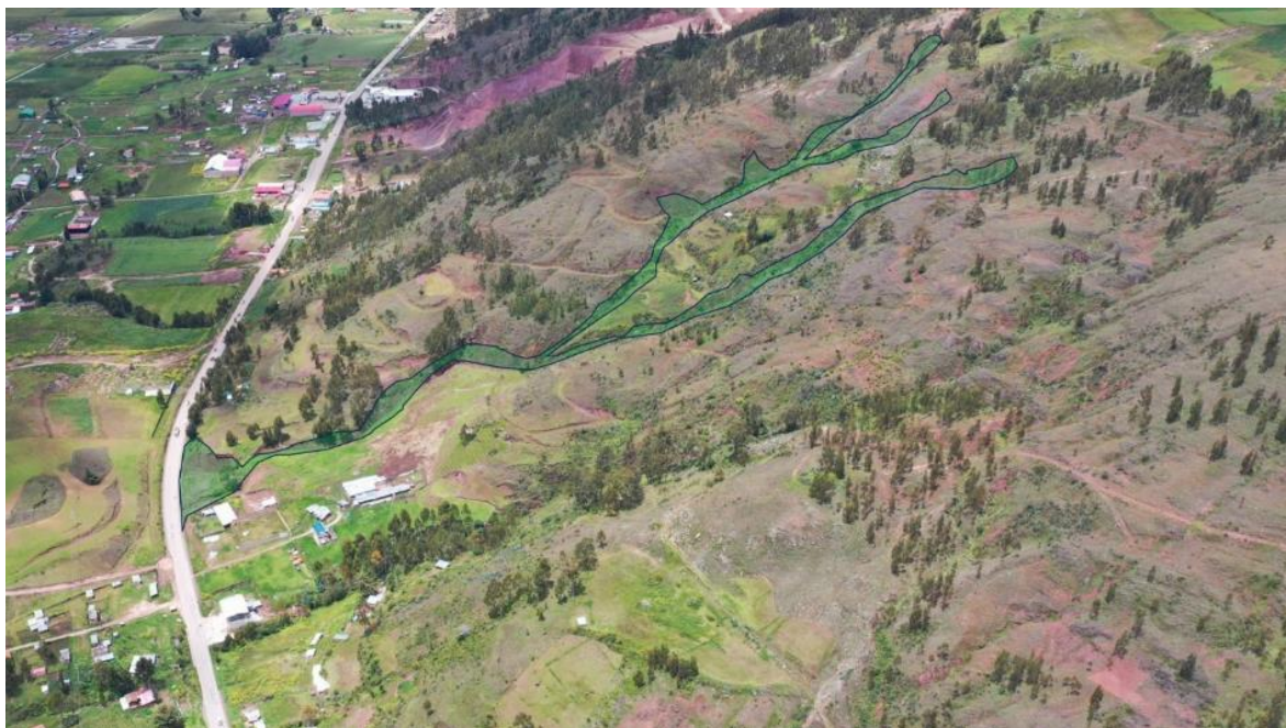
Figura 16: La cárcava 2 llega hasta la vía Panamericana Sur y presenta escasa cobertura vegetal, la cual la hace más susceptible a procesos de erosión de laderas.
