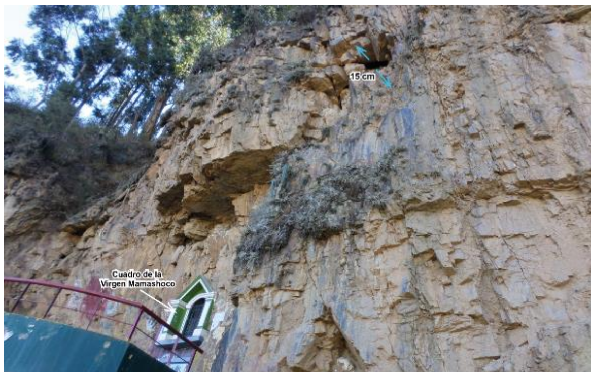
Figura 16. Vista del afloramiento de arenisca de la Formación Oyón, el cual se encuentra muy fracturada y meteorizada, en la parte alta se observa abertura de 15 cm, donde los fragmentos de rocas podrían caer ladera abajo afectando el mirador Mamashoco y personas que transitan por la zona.
