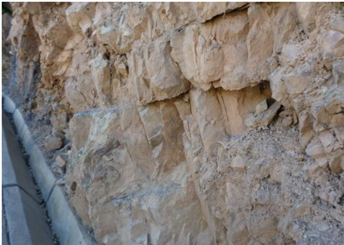
Fotografía 1. Afloramiento rocoso de la Formación Oyón que corresponden a areniscas cuarzosas de grano fino a medio, las cuales se encuentran medianamente fracturada con espaciamientos entre fracturas que van de 0.10 a 0.60 m, moderadamente meteorizada.
