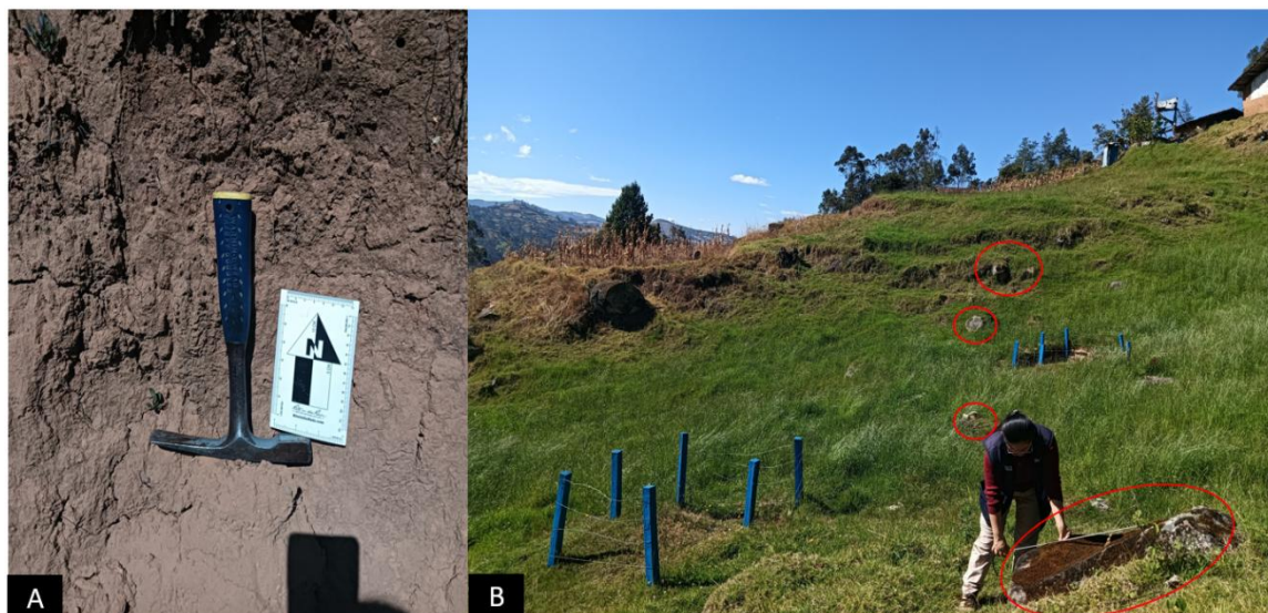
Figura 5. A. Matriz del depósito coluvio deluvial limo arcilloso. B. Bloques de rocas volcánicas dispersos y sueltos.
