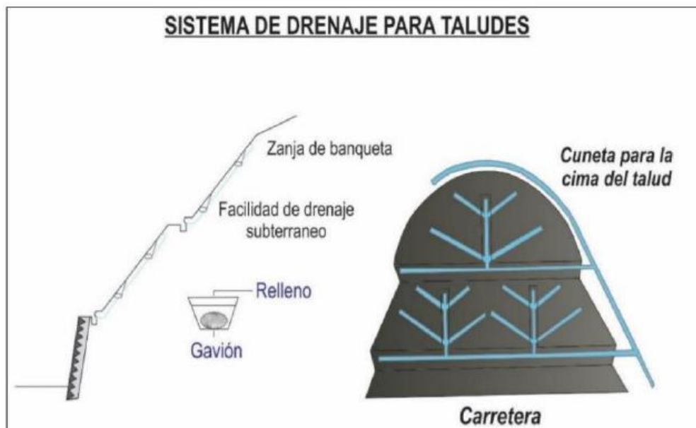
Figura 2.6. Drenaje tipo espina de pescado. Tomado de INGEMMET (2000).
