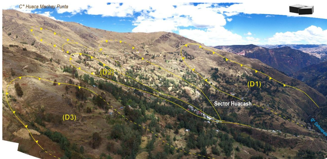
Figura 10. Geodinámica activa en la ladera norte del cerro Huaca Machay Punta, donde se muestra los deslizamiento-flujos y deslizamientos (D1, D2 y D3) que comprometen la estabilidad de la ladera y ponen el peligro latente a la población del sector Huacash.
