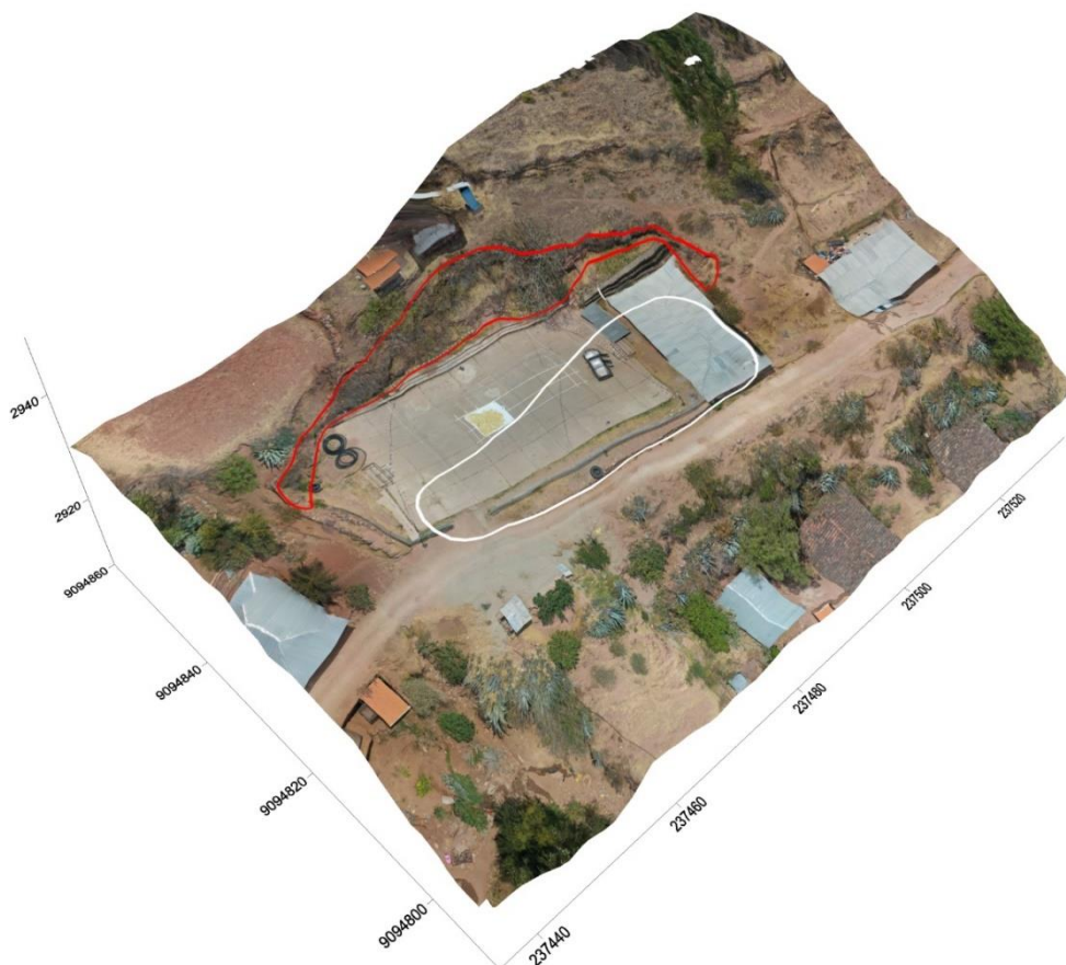
Figura 11. Modelo 3D del sector evaluado en la localidad de Carhuasuccha, el derrumbe está delimitado en línea roja, y el proceso de reptación de suelos en línea blanca, se aprecia la Institución educativa y plataforma deportiva afectadas por los movimientos en masa.
