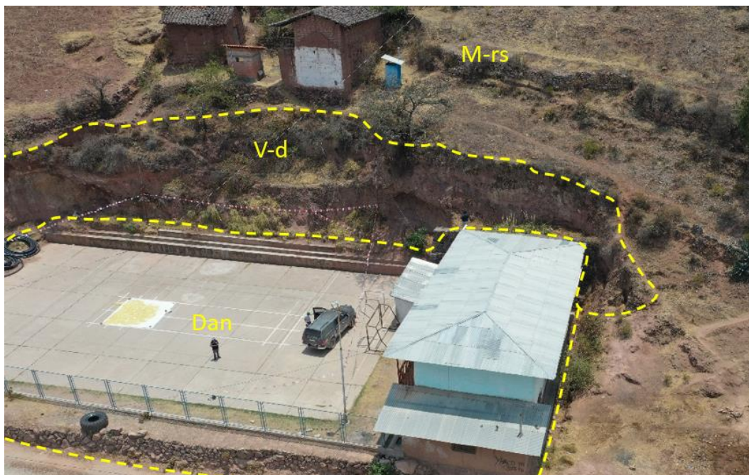
Figura 9. Vista de las geoformas de montaña en rocas sedimentarias (M-rs), y vertiente coluvial de detritos (V-d), y depósito antrópico (Dan), en el sector de Carhuasuccha.
