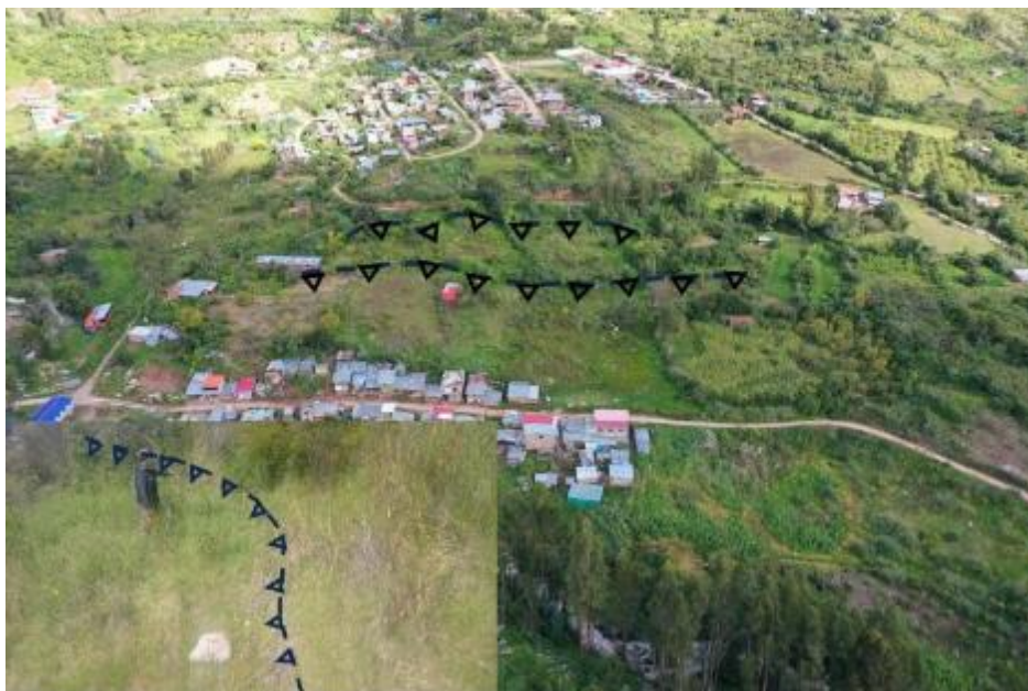
Figura 12: En la parte alta de la Agrupación vecinal se puede apreciar la escarpa de deslizamiento erosionada y con crecimiento de vegetación en algunos sectores
