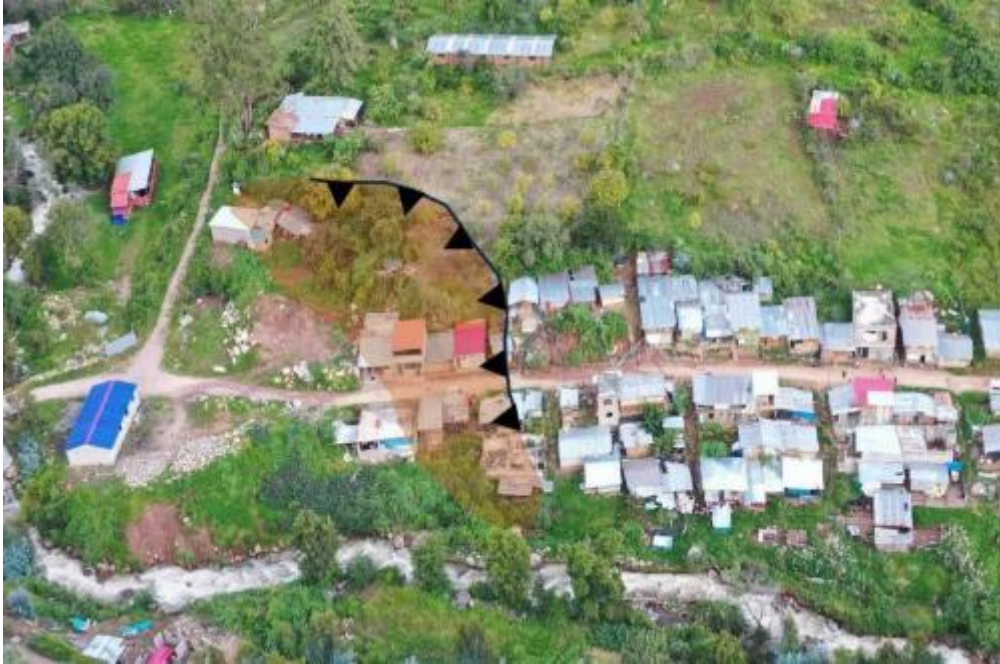
Figura 8. El deslizamiento afecta viviendas y fue generada por la infiltración del suelo y los cortes de talud.
