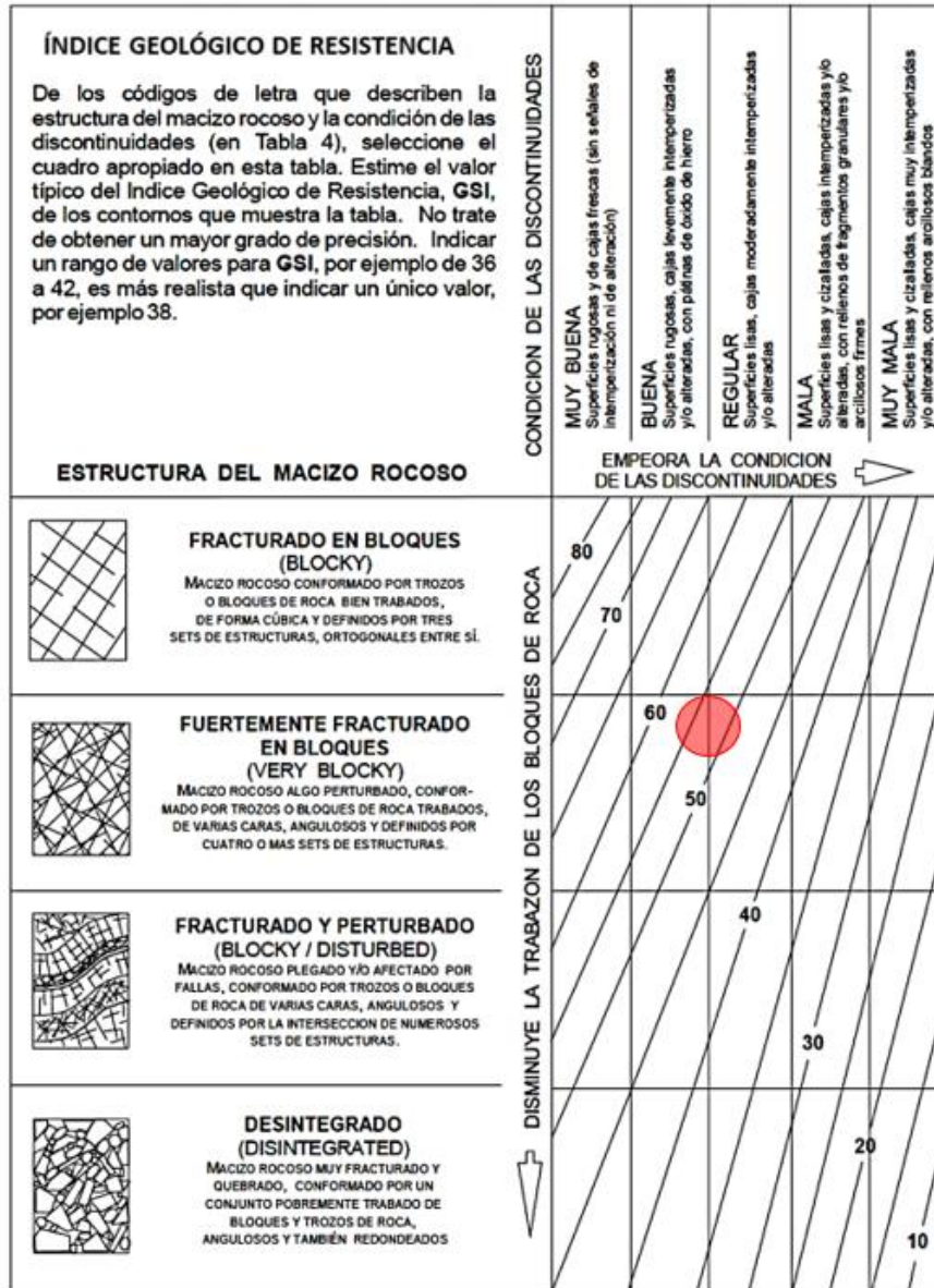
Figura 5. Estructura y calidad de las discontinuidades de los macizos rocosos de la Formación Chúlec presente en la zona de estudio.
