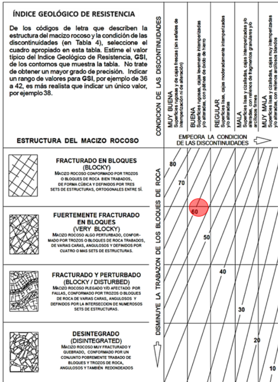
Figura 3. Estructura y calidad de las discontinuidades de los macizos rocosos de la Formación Farrat presente en la zona de estudio.
