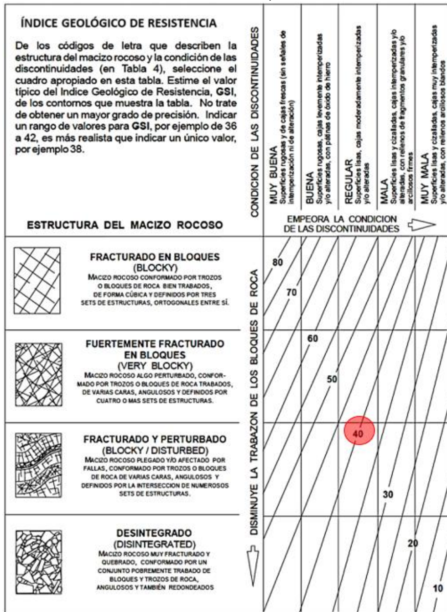
Figura 8. Estructura y calidad de las discontinuidades de los macizos rocosos de la Formación Yumagual presente en la zona de estudio.
