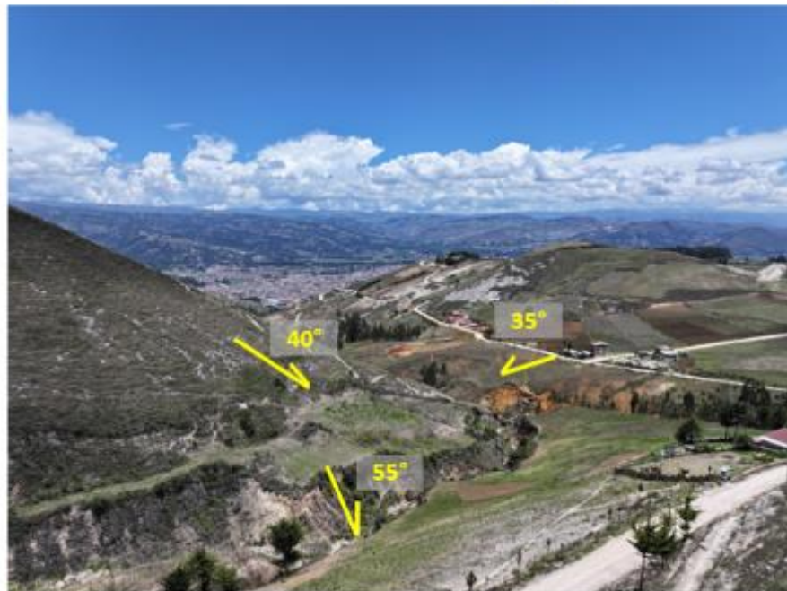
Figura 14. Modelo 3D de las pendientes en la localidad de Urubamba Sector III, en color amarillo polígonos de peligros identificadas y pendientes con flecha amarilla.
