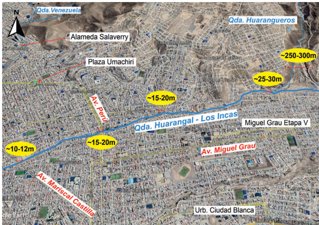
Figura 4. Imagen satelital que muestra los afluentes de la quebrada Huarangal-Los Incas en la ciudad de Arequipa. El área en amarillo indica el ancho de la quebrada.
