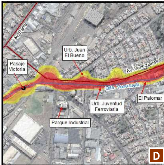
Figura 33. Zonas críticas distinguidas a lo largo de la quebrada Venezuela.
