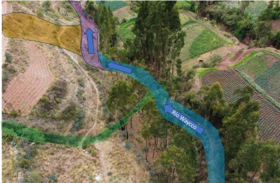
Figura 11. La cárcava llega al canal de la quebrada y se aprecia su ubicación con respecto al deslizamiento.
