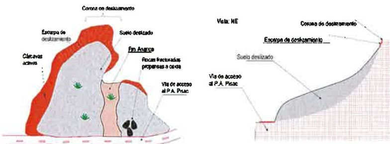
Figura 109. Bloques de rocas se encuentran en suspensión con bastante fracturamiento a una altura de 5 m y el talud tiene alta pendiente y cárcavas en la base. Ubicado en las coordenadas 8516344N, 192345 E.
