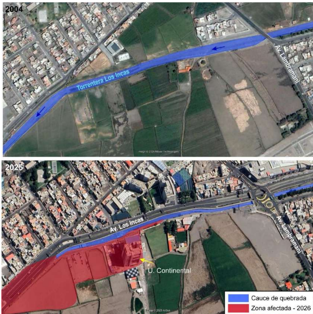
Figura 11. Reducción del cauce de la Quebrada Los Incas entre los años 2004 y 2025.
