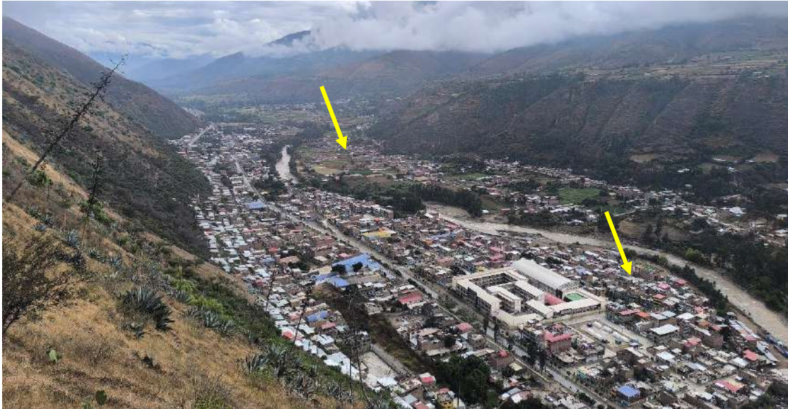
Fotografía 12: Terraza aluvial (flecha de color amarillo) sobre la que se asienta el área urbana del distrito de Ambo
