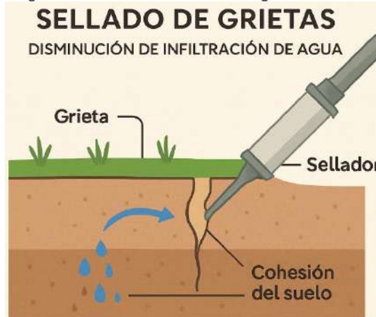
Figura 22: Metodo de Sellado de grietas
