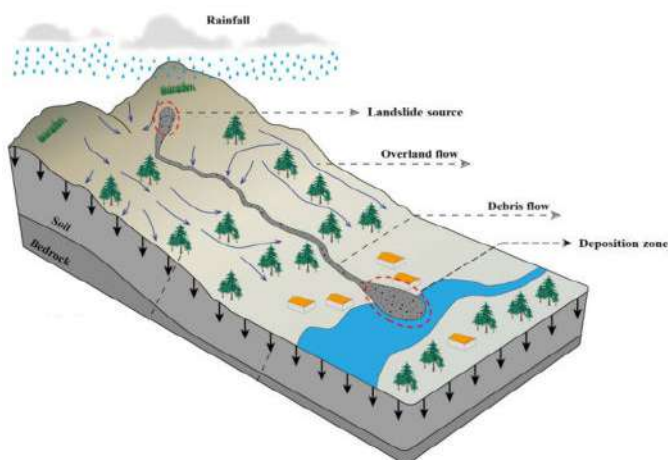
Figura 8: Esquema de la generación de un flujo de detritos y transporte de sedimentos.
