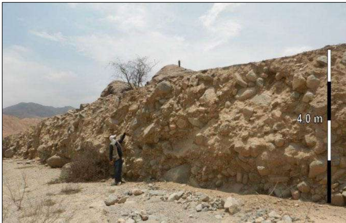
Figura 4: Se observa el depósito proluvial conformado por bloques de gran tamaño, tanto en su base como en la zona superior, así como también conformado por bolones, gravas, contenidos en una matriz areno limosa.
