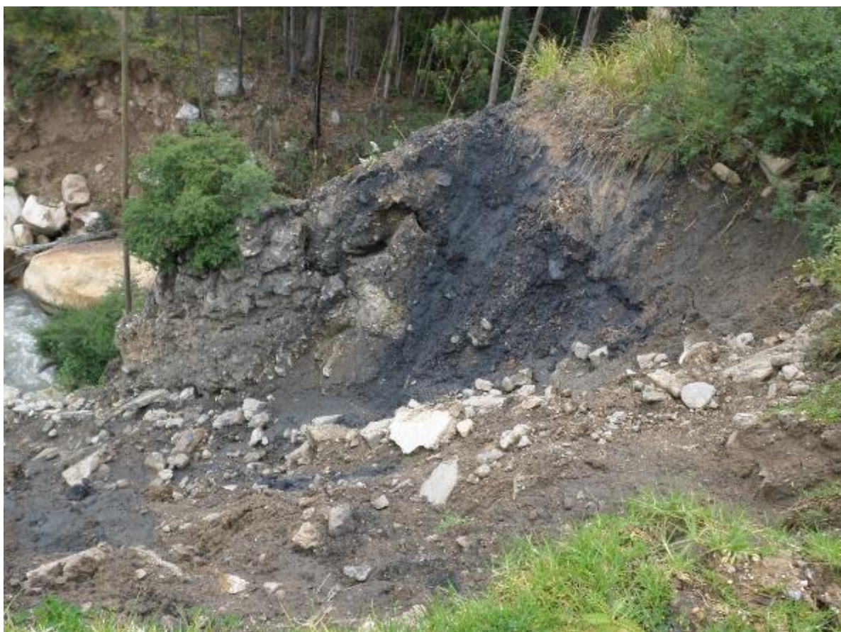
Fotografía 1. Vista del depósito coluvial conformada por bloques (15%), gravas (30%), arena (20%), arcilla y limo (35%), se puede observar que corresponde a un depósito inconsolidado, producto de derrumbes, con dirección hacia el río Huaritambo.
