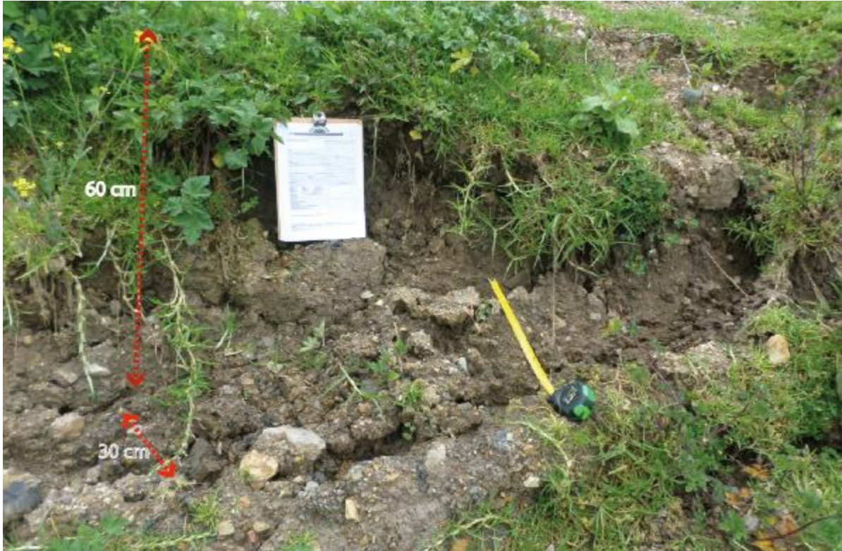
Figura 9. Vista del escarpe principal del deslizamiento rotacional, presenta un salto de 60 cm con 30 cm de desplazamiento horizontal.
