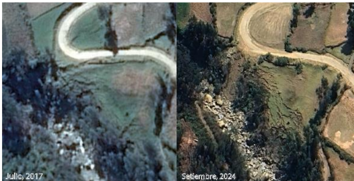
Figura 16. Vista Imagen satelital multitemporal 2017-2024, donde se visualiza la actividad en la ladera ubicada en la margen izquierda del río Huaritambo, se parecían derrumbes y reptación de suelos, se incrementaron en el tiempo.
