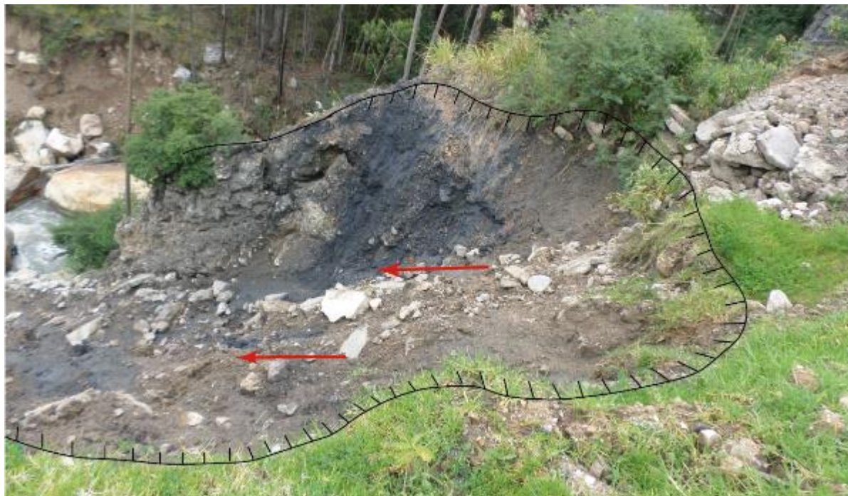
Figura 14. Vista del derrumbe, el cual podría ser también reactivado en temporada de lluvias por la erosión fluvial que ejerce el río Huaritambo, se puede distinguir material coluvial que fue depositado al pie del talud.
