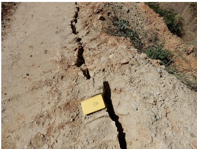
Figura 12. A) Deslizamiento activo ubicado en la parte media baja del cerro Allgayhuachana, margen izquierda de la quebrada Ñahuirajra. B) Grietas tensionales ubicadas en la corona y escarpe principal del deslizamiento, que afectan una trocha temporal. C) Grietas tensionales concentradas en el cuerpo del deslizamiento, revelan deformaciones internas y movimiento activo del evento.
