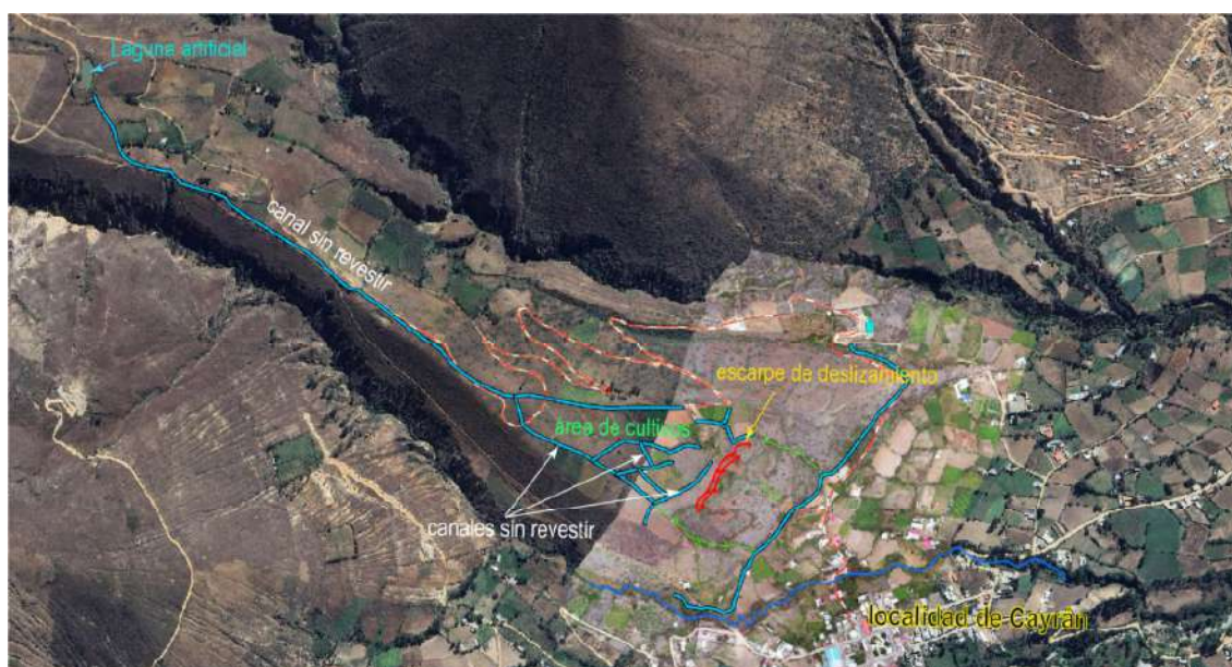
Figura 14. Imagen ortomosaico en traslape con imagen satelital de Google Earth, donde se muestra la laguna artificial ubicado a 1.4 km del escarpe principal del deslizamiento. Además, se observan los canales sin revestir que sirven como medios de riego para las áreas de cultivos localizados sobre la corona del deslizamiento. Estos factores sobresaturan los suelos incompetentes ocasionando la pérdida progresiva de la resistencia al corte y que podrían desencadenar eventos de gran magnitud que impacten directamente sobre pobladores de la localidad de Cayrán, si persisten las mismas condiciones.
