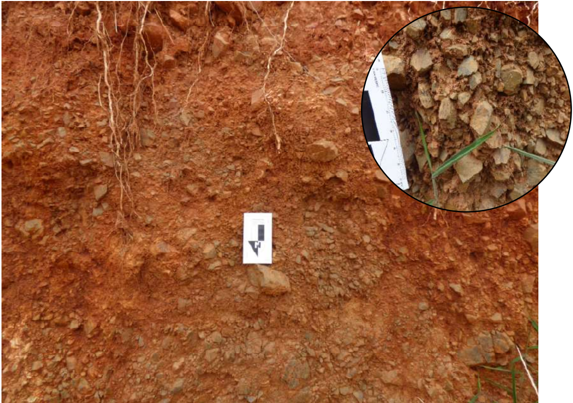
Figura 7. Detalle del depósito proluvial, donde se observa fragmentos heterométricos subangulosos de tipo clasto soportado con una matriz incipiente, constituida por limo y arena.
