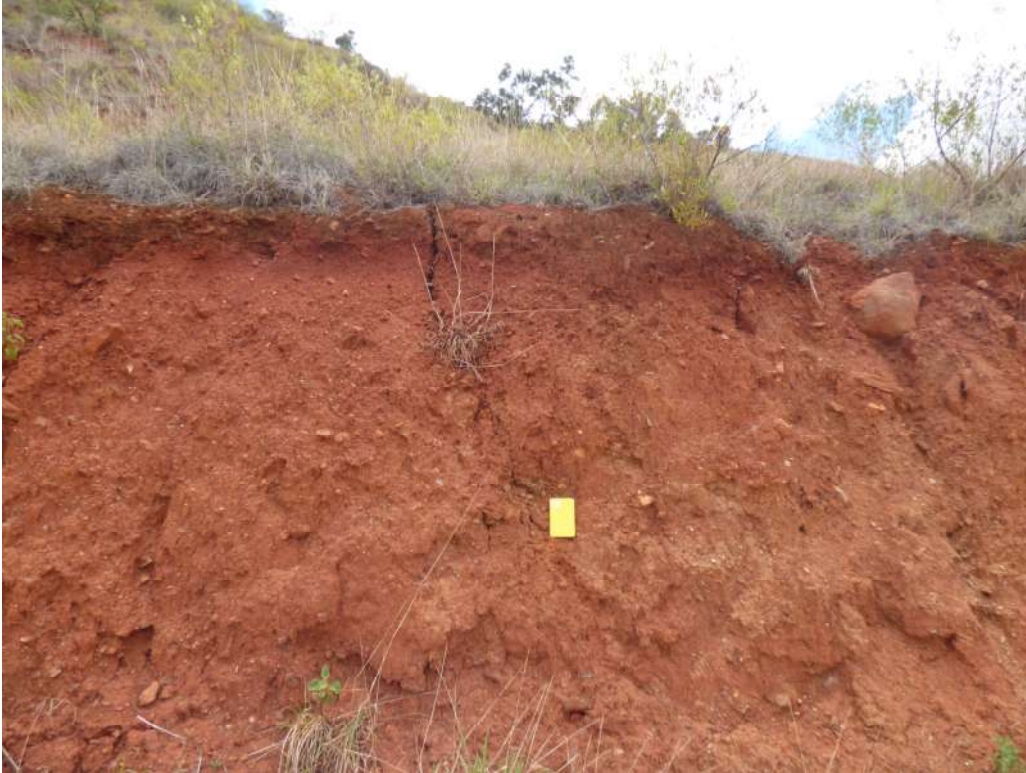
Fotografía 1. Corte de carretera donde expone depósitos coluvio-deluviales, ubicados en la ladera media del cerro Pachamuña, en el sector Lloque.
