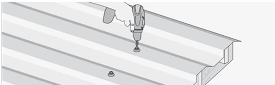
**Figura 7:** Techos ligeros que deben estar sujetos adecuadamente a fin evitar caídas o desprendimientos
