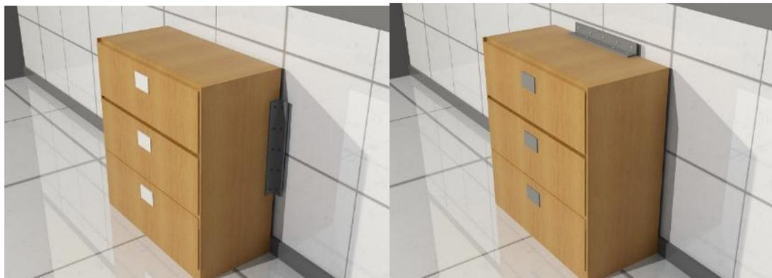
**Figura 19:** Archiveros deben estar asegurados y evitar caídas que obstruyan salidas o corredores de evacuación. .
