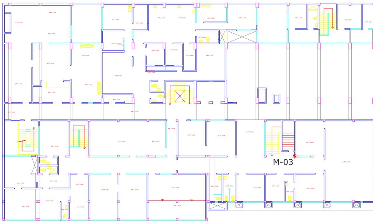
**Figura 13.** Ubicación de puntos de extracción de núcleos de concreto en el segundo piso.
