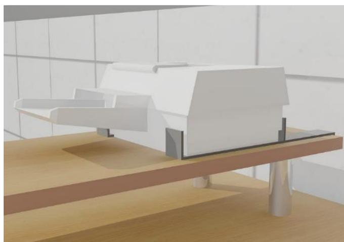
**Figura 18:** Equipos como impresoras deben estar sujetos a asegurados para evitar su desplazamiento ante movimientos sísmicos e fijados y estabilizados y las puertas permanecerán cerradas. Las estanterías deben tener bordes levantados para que los productos, materiales u objetos contenidos no salgan disparados. Los contenedores y otros grandes volúmenes de almacenamiento deben estar cerrados y enganchados a los estantes.
