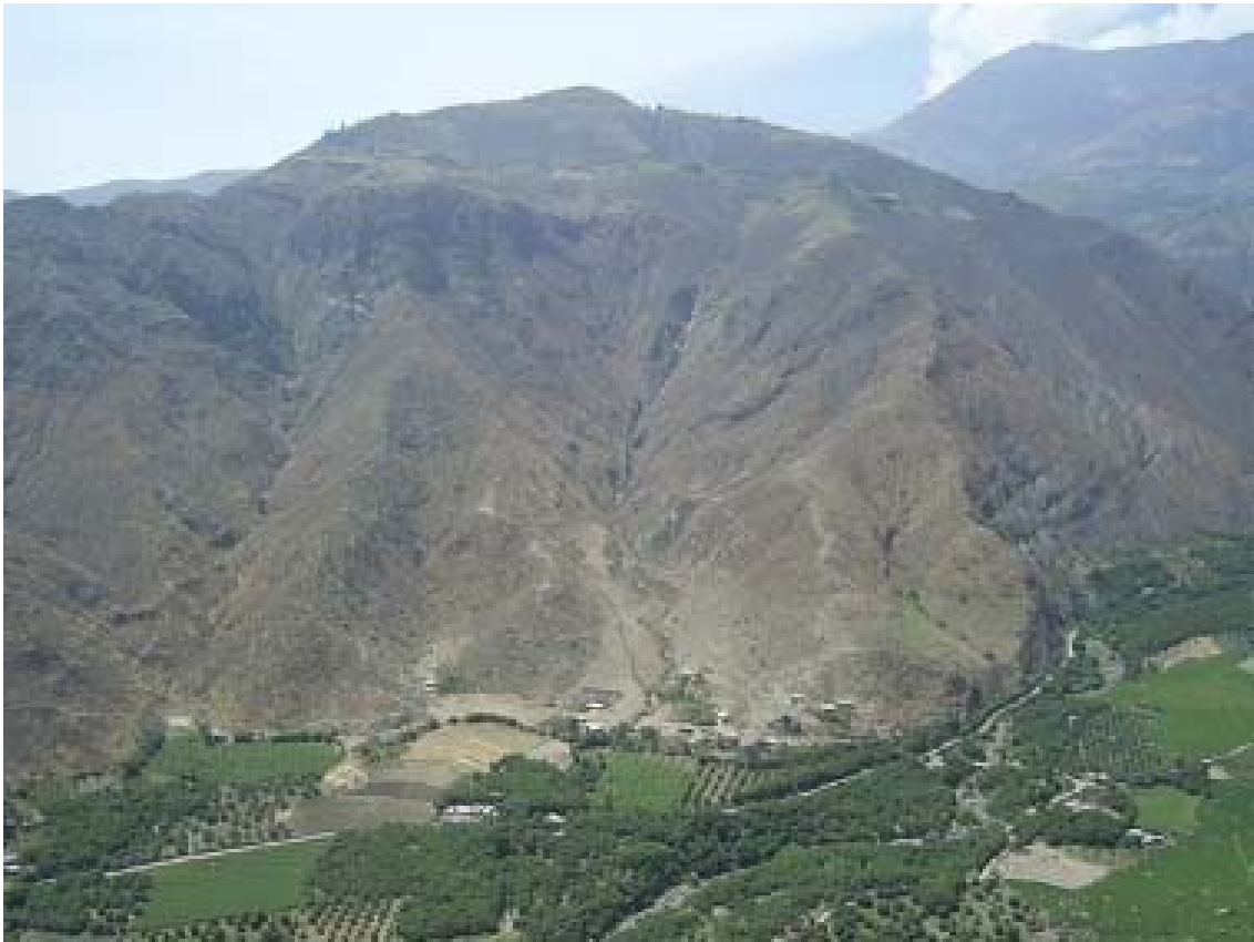
Torrenteras afectadas por donde discurren huaycos de manera excepcional, se asientan viviendas en los depósitos de huaycos antiguos, San Luís, Unión Agua Blanca.
