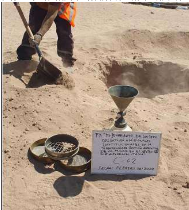
Gráfico N° 25. Calicata C-02 resultado del material Natural del EMS
