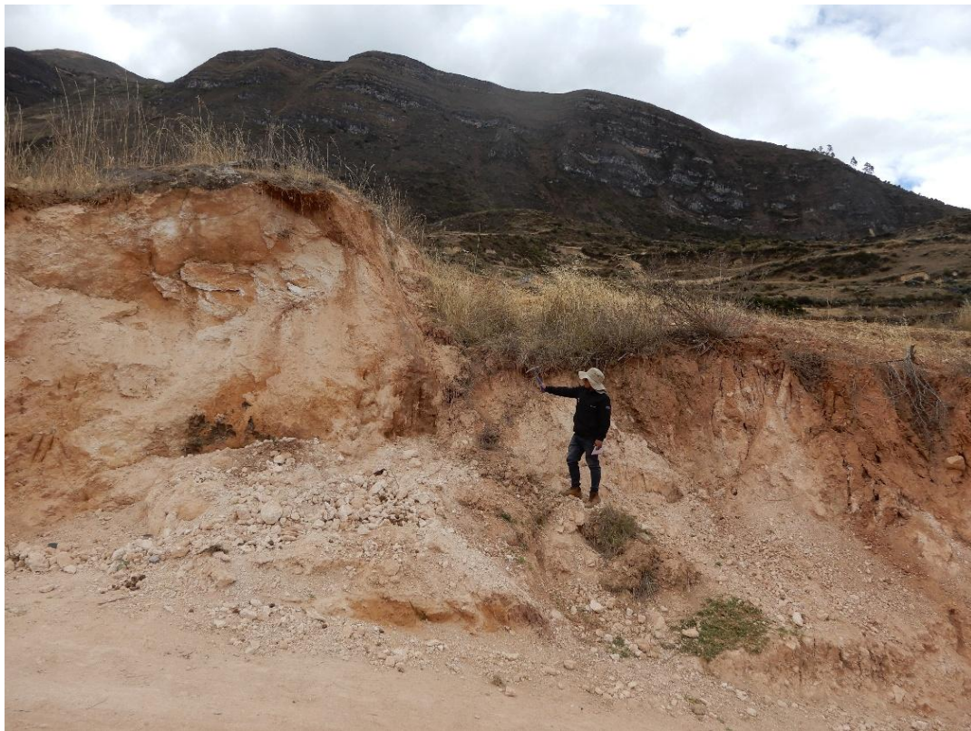
Fotografía 9. Salto de 2.5 m del escarpe principal en el flanco derecho del deslizamiento activo. Vista mirando al oeste.
