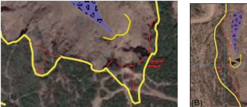
Figura 6A. Se muestra el avance retrogresivo que ha tenido el deslizamiento. Figura 6B. Presenta un avance lateral izquierdo. (Líneas rojas el antiguo escarpe, líneas amarillas el nuevo escarpe).
