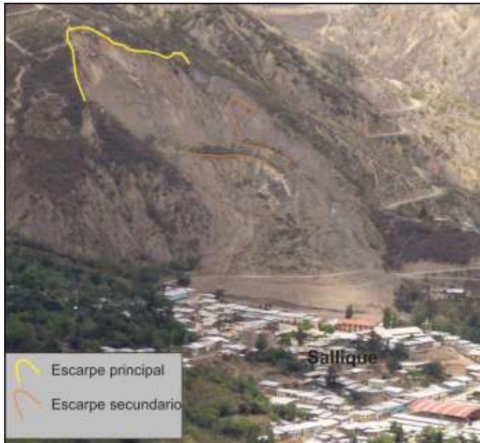
Foto 7. Se muestra la línea de escarpa principal (color amarillo) y las escarpas secundaria (color marrón).
