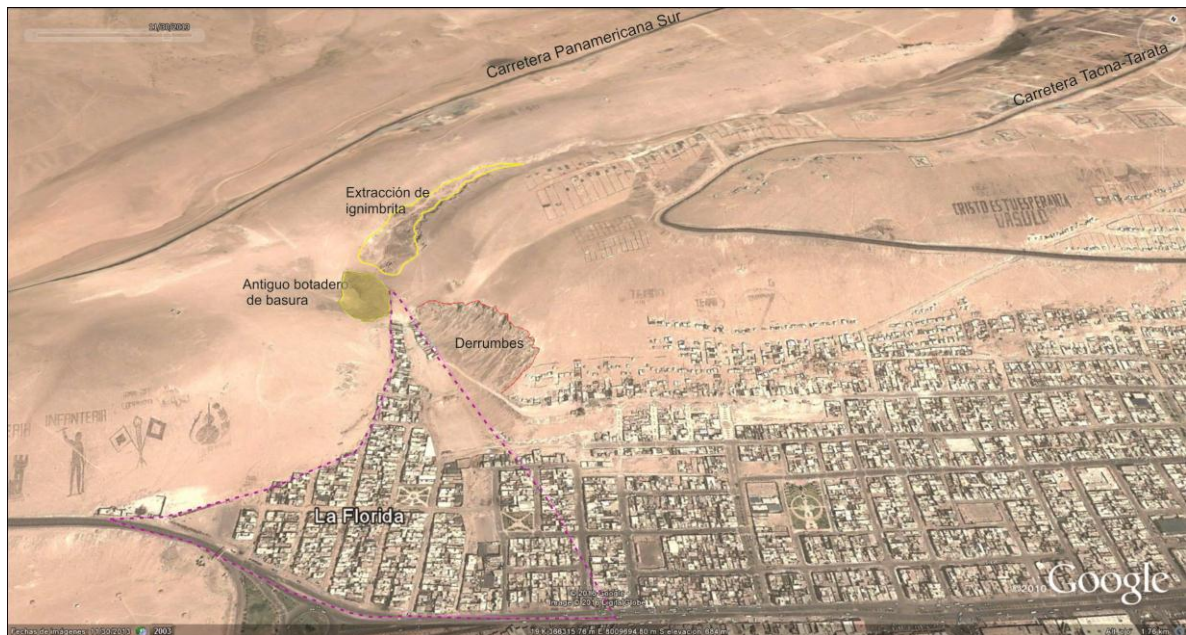
Figura 7. Vista aguas arriba de la quebrada Del Diablo obstruido por la construcción de viviendas, desmontes y botadero de basura (marcado con línea roja). La Florida se ubica asentado sobre el depósito antiguo de la quebrada Del Diablo.
