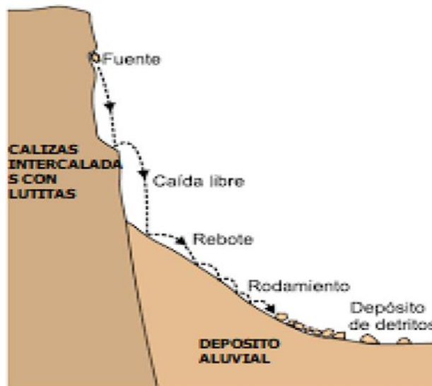
Ilustración 5 Esquema del recorrido de las rocas en caída
