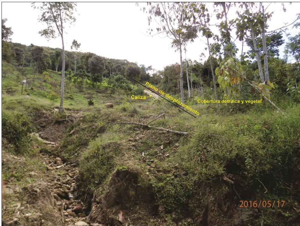
Foto 7. Vista tomada a la margen derecha de la quebrada Oyón, se observa el plano de desplazamiento de la cobertura detrítica y vegetal sobre las calizas de la Fm. Chonta.
