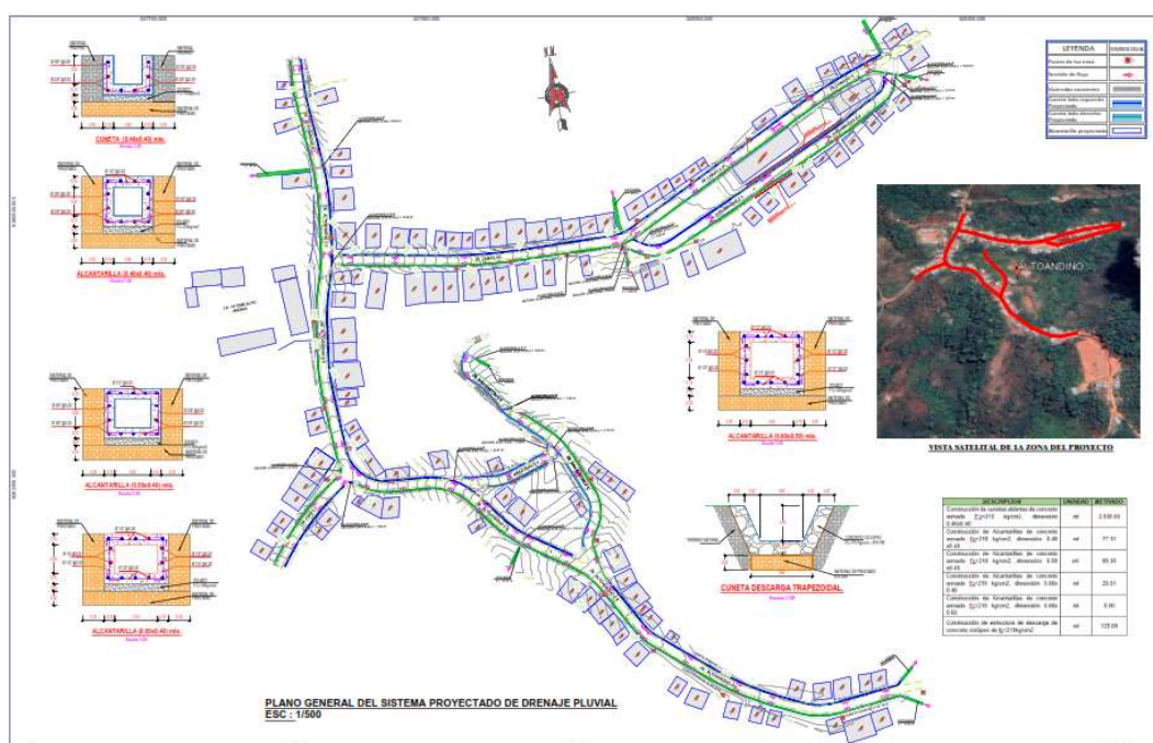
Figura N°15: Sistema de drenaje pluvial proyectado
