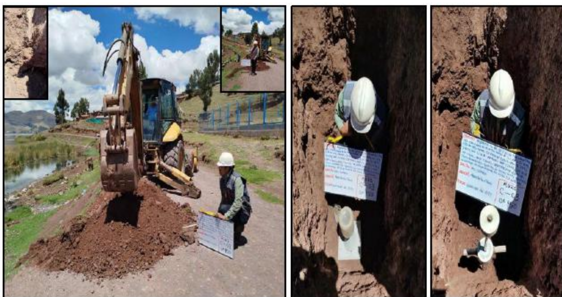
Imagen 15 Fotografías de la calicata realizada para el estudio de mecánica de suelo
