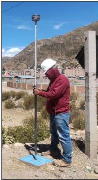
FOTOGRAFIA N°01.- UBICANDO LOS PUNTOS DE CONTROL Y REMARCADO
