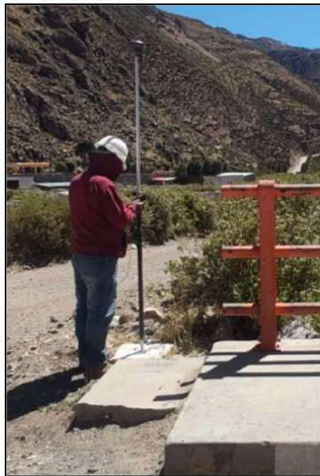
FOTOGRAFIA N°01.- UBICANDO LOS PUNTOS DE CONTROL Y REMARCADO
