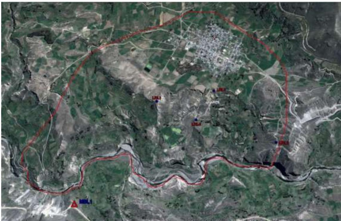
**Figura 1.** Vista general de la zona de estudio del deslizamiento de Lari, la línea roja indica el área en estudio, el triángulo color rojo es la estación para monitoreo mediante scanner 3D Lidar, los puntos color azul son estaciones de monitoreo con GPS.
