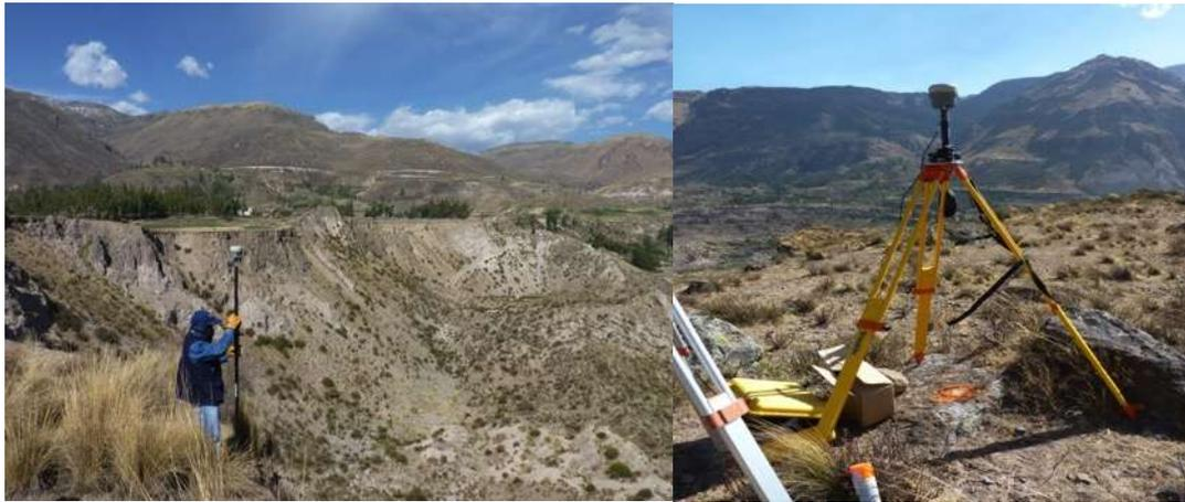
**Figura 3.** Vista general del monitoreo con GPS diferencial, a) Instante del levantamiento mediante el método cinemático continuo de la principal escarpa de Lari, b) Base de la estación GPS Diferencial ubicado en el extremo norte de la escarpa.
