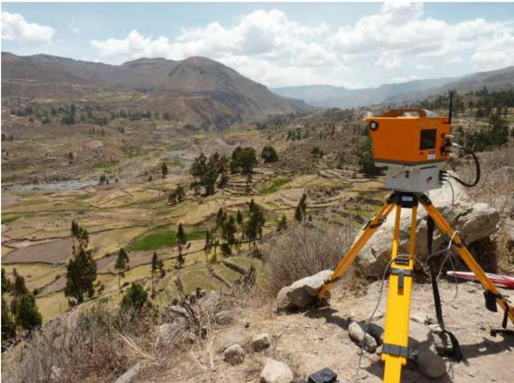
**Figura 2.** Instante de la obtención de la nube de puntos con scanner 3D LiDAR del deslizamiento de Lari, equipo ubicado frente al deslizamiento (extremo izquierdo del río Colca).
