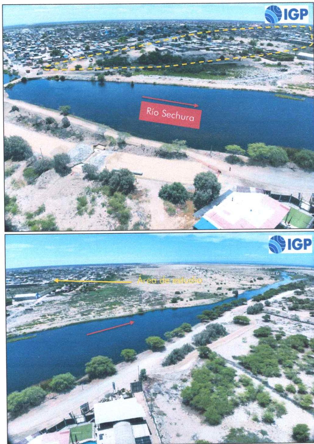
Figura 4.- Unidad geomorfológica lecho fluvial del río Sechura, cuyo cauce presenta un ancho variable entre 60 y 97 m en el tramo evaluado. En la imagen superior se observa el área de estudio ubicada sobre la margen izquierda del cauce; mientras que la imagen inferior muestra una vista del río aguas abajo, donde se aprecia la configuración del lecho fluvial y sus márgenes.
