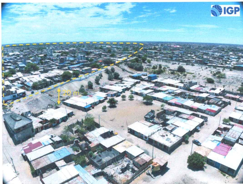
Figura 10.- Unidad geomorfológica de terraza aluvial alta (delimitada por el polígono amarillo), caracterizada por constituir una superficie llana que presenta un desnivel topográfico superior de 20 m.
