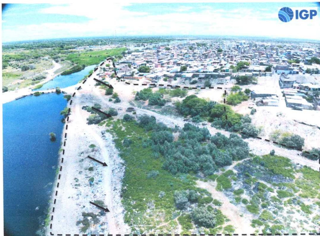
Figura 8.- Unidad geomorfológica llanura de inundación en el margen izquierdo del río Sechura delimitada sobre una imagen aérea que muestra posibles afectaciones sobre el extremo norte del A.H. Las Peñitas. Las flechas negras indican la dirección del flujo del agua hacia las zonas inundables.
