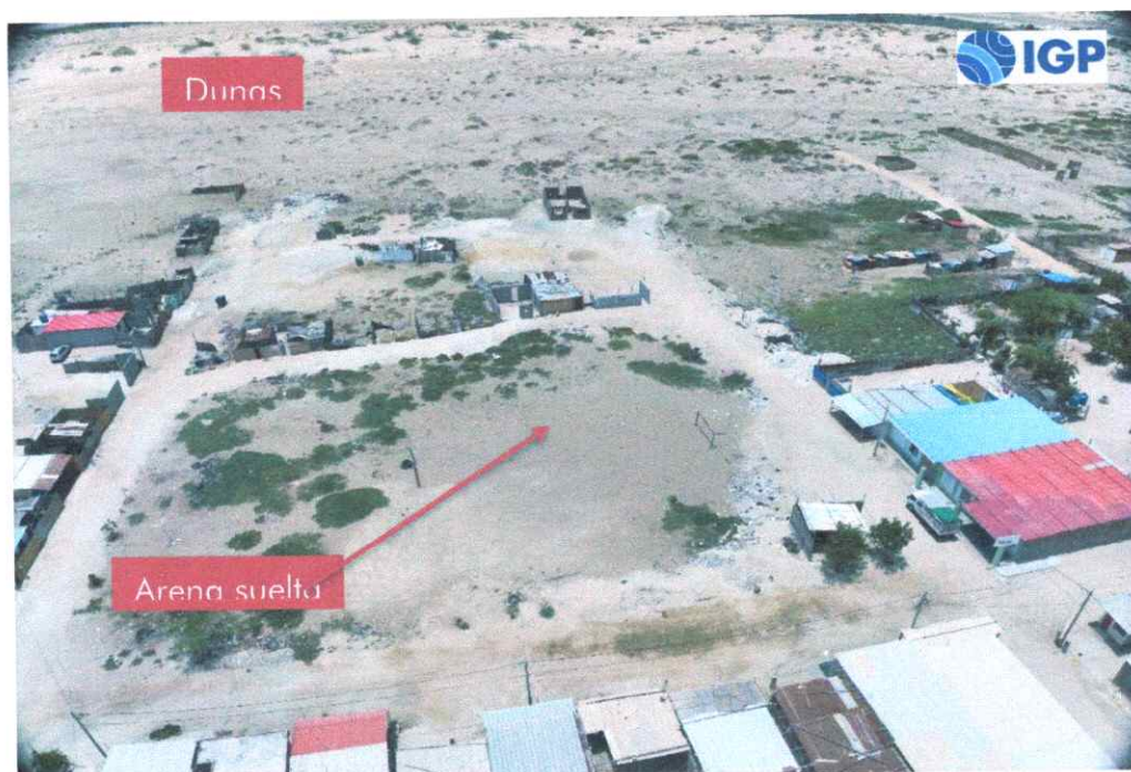
Figura 17.- Depósito eólico conformado por arenas finas transportados por acción del viento que fueron reconocidas en las inmediaciones del A.H. Virgen del Carmen, donde dicha unidad geológica ha sido intervenida por el asentamiento de viviendas
