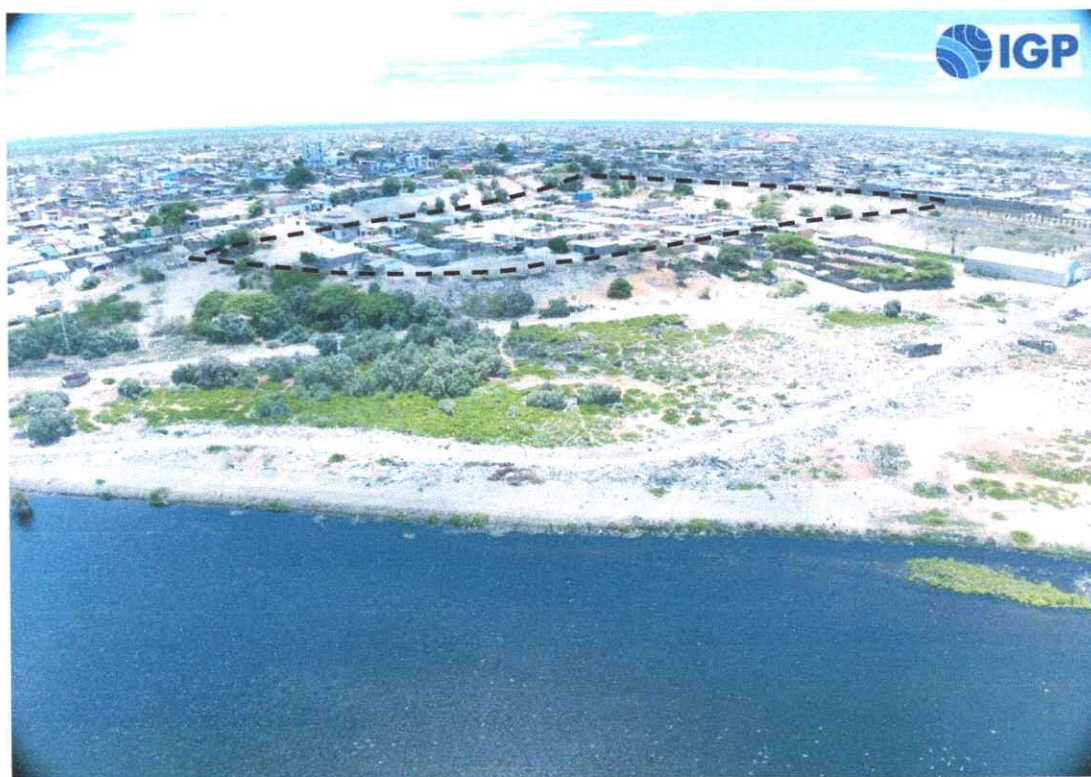
Figura 9.- Unidad geomorfológica de terraza aluvial baja (delimitada por el polígono negro), caracterizada por constituir una superficie relativamente llana que presenta un desnivel topográfico aproximado de 2 a 4 m respecto a la llanura de inundación adyacente al río Sechura. Sobre esta unidad geomorfológica se ubican los asentamientos humanos Los Pinos, Virgen del Carmen, Cristo Rey, 3 de enero y Las Peñitas.
