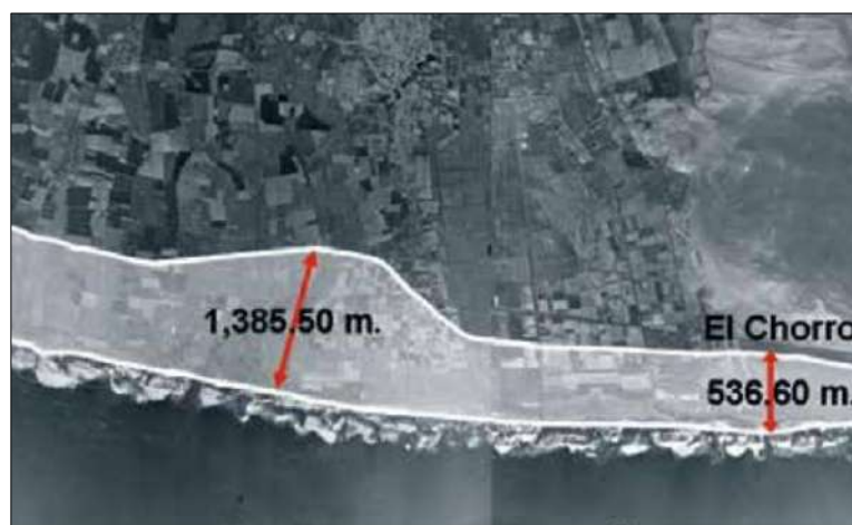
Figura 6. Inundacion por tsunami en zona agrícola - Camaná
