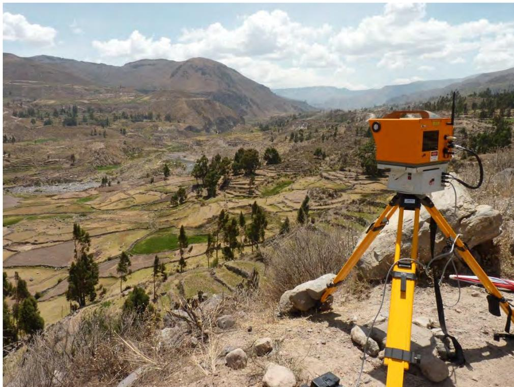
Foto 20: LiDAR instalado frente al deslizamiento de Lari, tomando las primeras de prueba y calibración del equipo.
