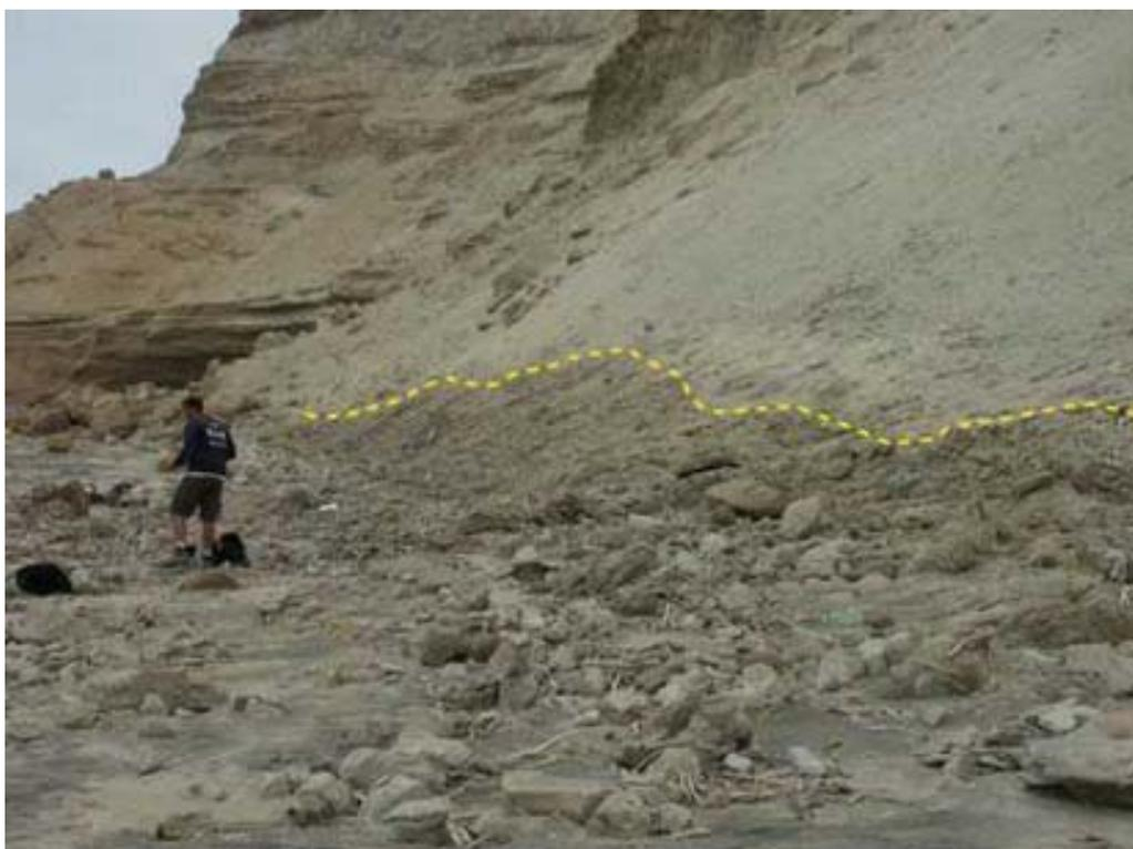
**Fotografía 3.3** La línea de inundación en playa la Chira está marcada por una línea de escombros y un cambio de color en la ladera por encima de la playa. El más alto nivel medido se encuentra a 8.2 m y fue a lo largo de este tramo de la playa (fotografía tomada de Jaffe et al., 2003).
