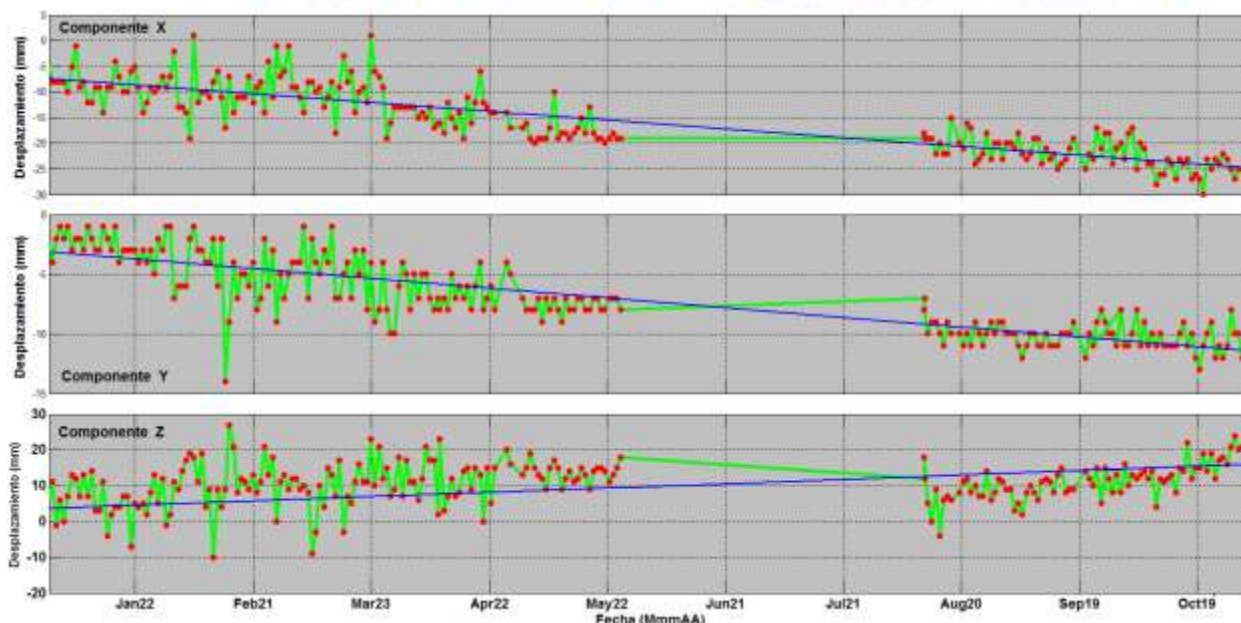
Figura 5.2. Comportamiento de las coordenadas de la estación SBMU para un periodo comprendido entre enero a diciembre de 2015.
