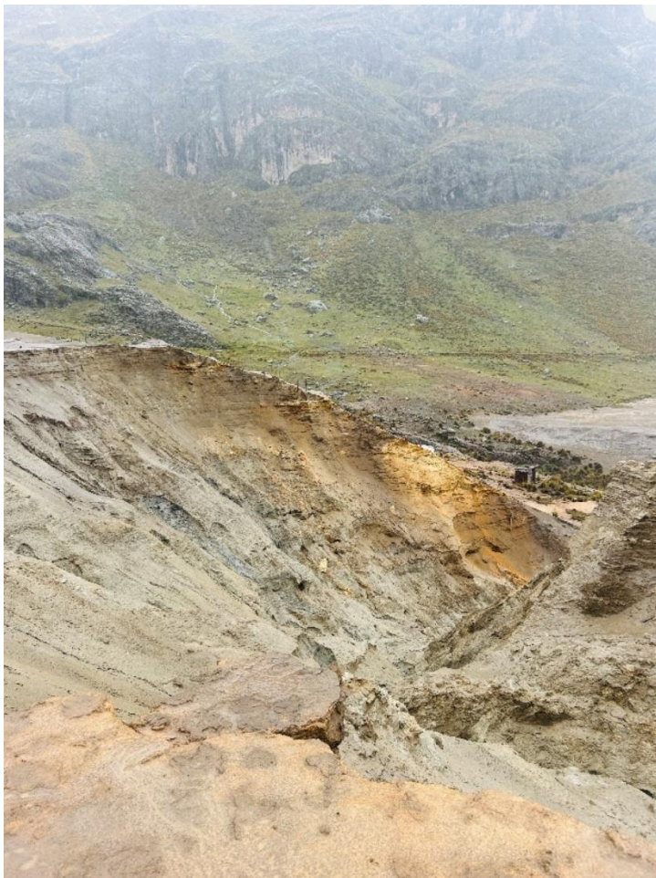
Fotografía 2. Depósitos antrópicos constituidos por relaves de la ex unidad minera “Huampar”. Coordenadas WGS 84, 18L, X: 342684 m E; Y: 8720272 m S.
