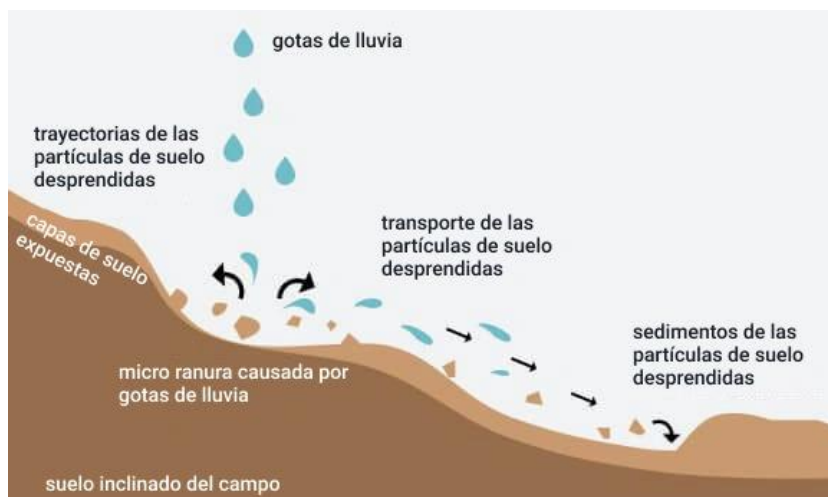
FIGURA 14: ESQUEMA DE EFECTOS DE LA EROSIÓN HÍDRICA EN SUELOS CON DESNIVEL
