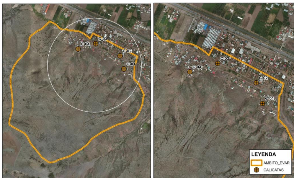
FIGURA 21: CALICATAS DE SUELOS Y ROCAS EN EL ÁMBITO DE ESTUDIO
