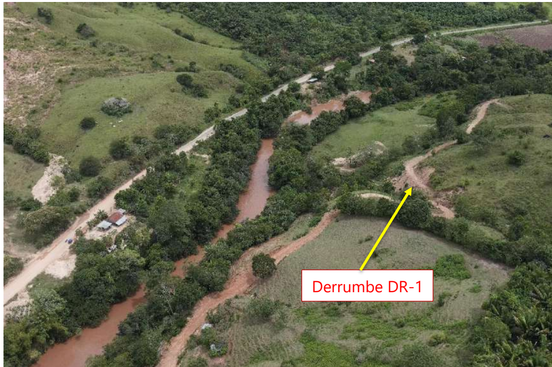
Figura 33.- Derrumbe DR-1 situado en la vía de acceso contigua al margen izquierdo del río Sisa
