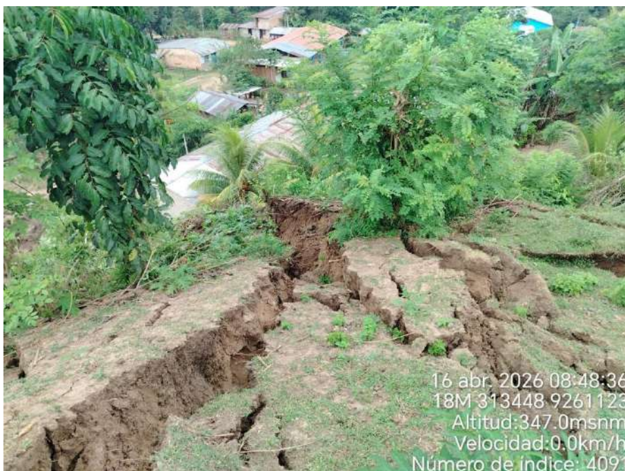
Foto N° 22: Deslizamiento rotacional con dirección hacia viviendas.
