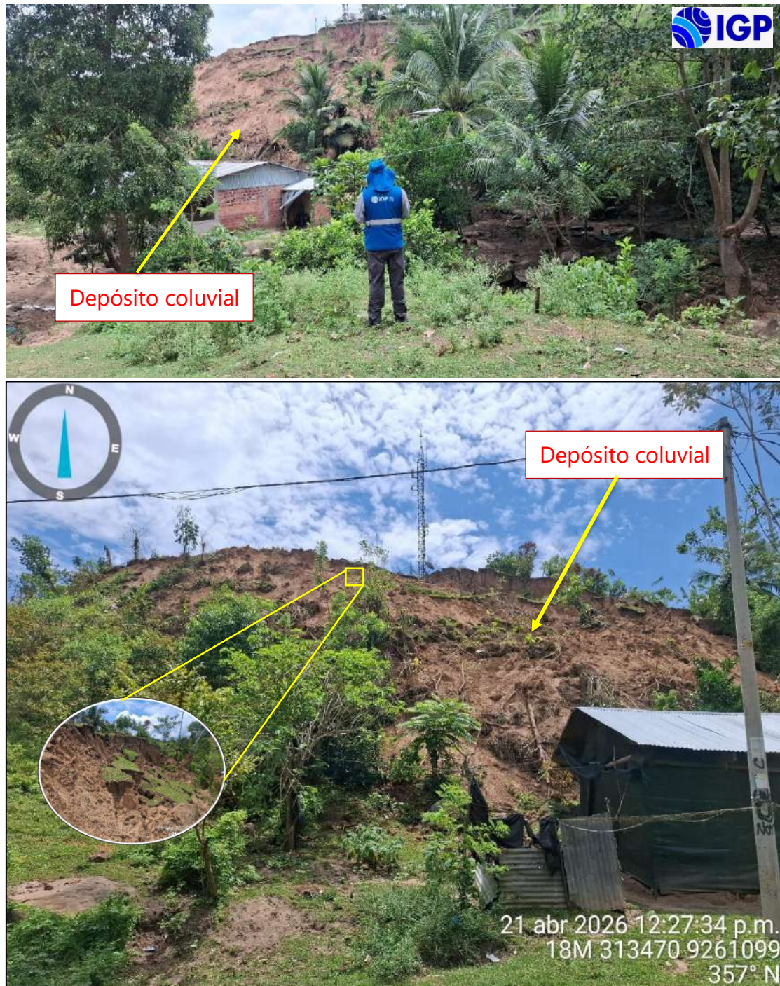
Figura 15.- Depósito coluvial conformado por material suelto (arenas y limoarcillas) generados por activación de deslizamiento en colina sobre la cual se asienta la IEI N° 429 Eladio Tapullima
