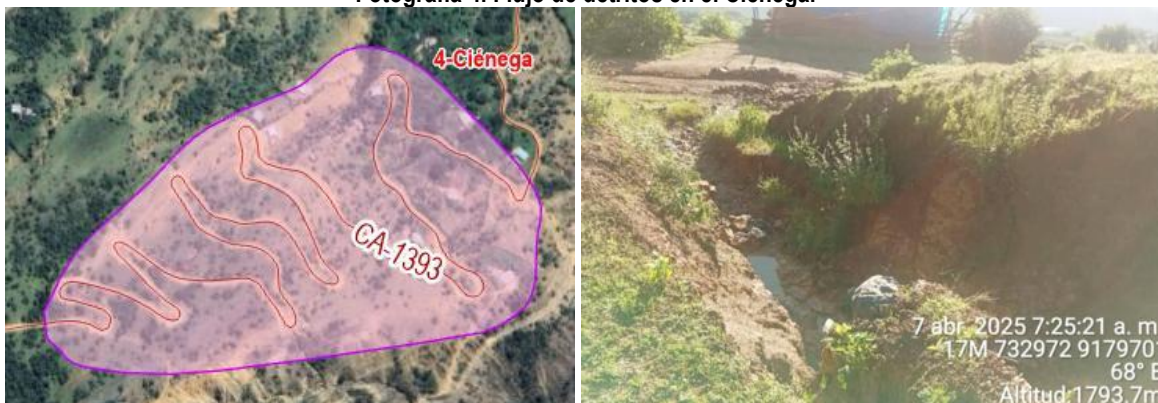
Fotografía 4. Flujo de detritos en el Ciénega.
