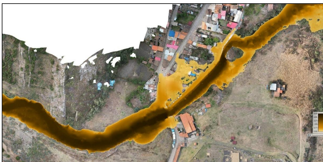
Figura 113. Altura máxima del flujo de detritos en la zona norte y oeste del monumento arqueológico Fuente: Equipo Técnico EVAR Monumento Arqueológico Chavín de Huántar (2025)
