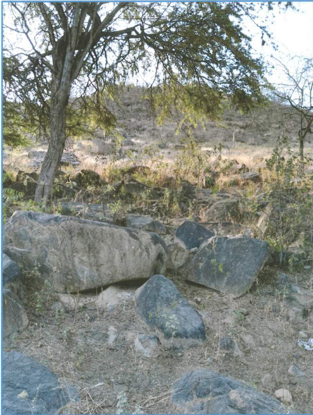
Figura 32.- Cantera de Rocas 02 que está formando parte de los afloramientos rocosos del Volcanico Porculla, compuesto principalmente de rocas dacíticas. Compactas, muy duras.
