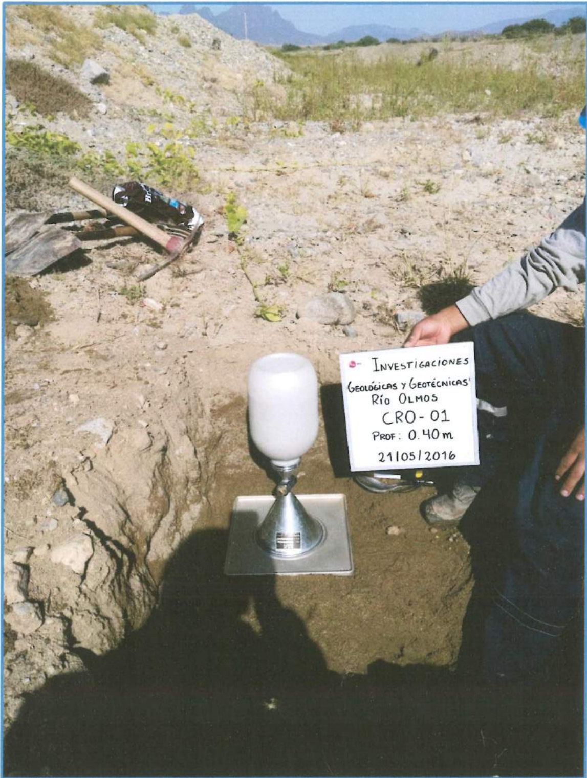
Figura 15.- Calicata CRO-01. Realizando prueba de densidad natural de campo.
