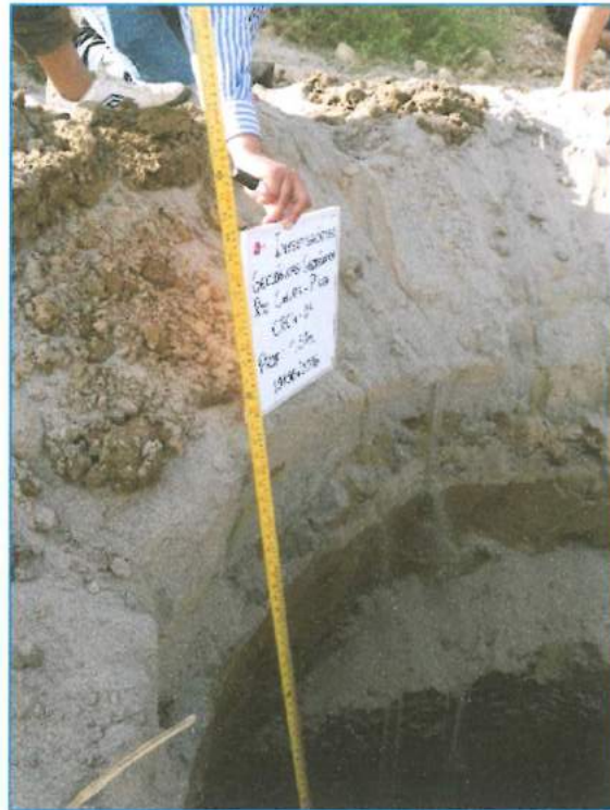
Figura 24.- Calicata CRCH-04 Hacia el tope se observa arena limo arcillosa
