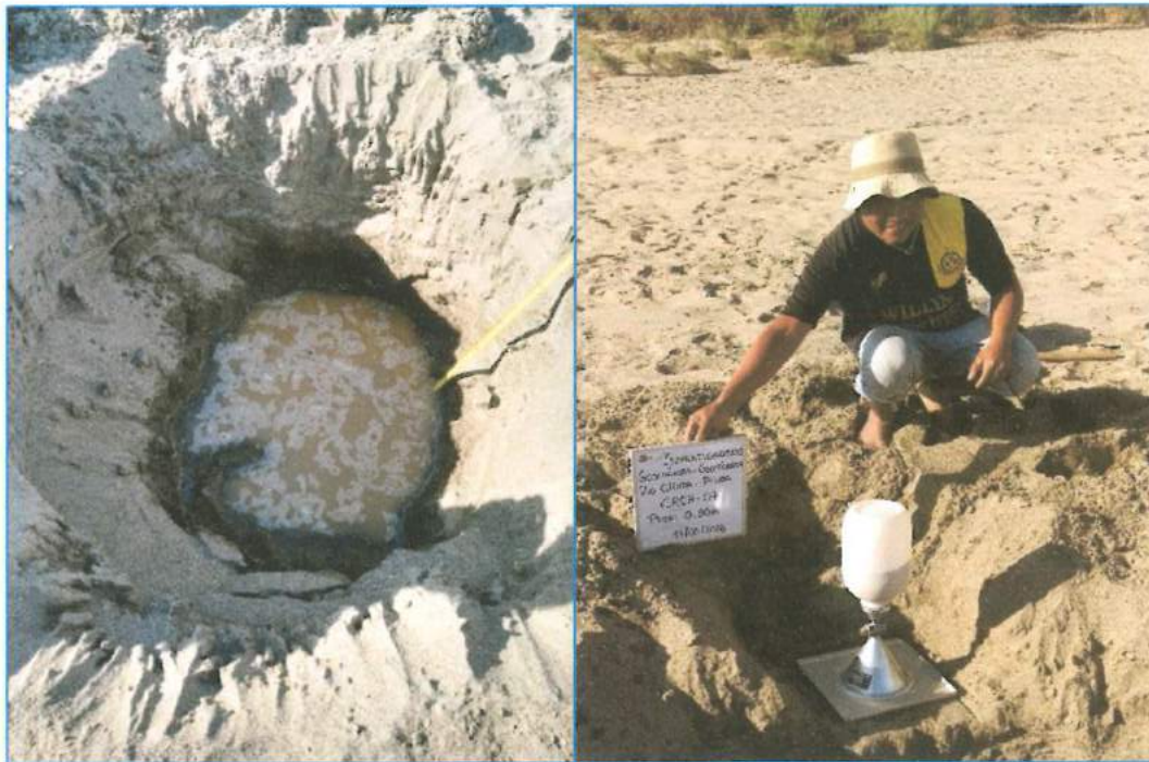
Figura 31.- Calicata CRCH-07 Arena fina.
