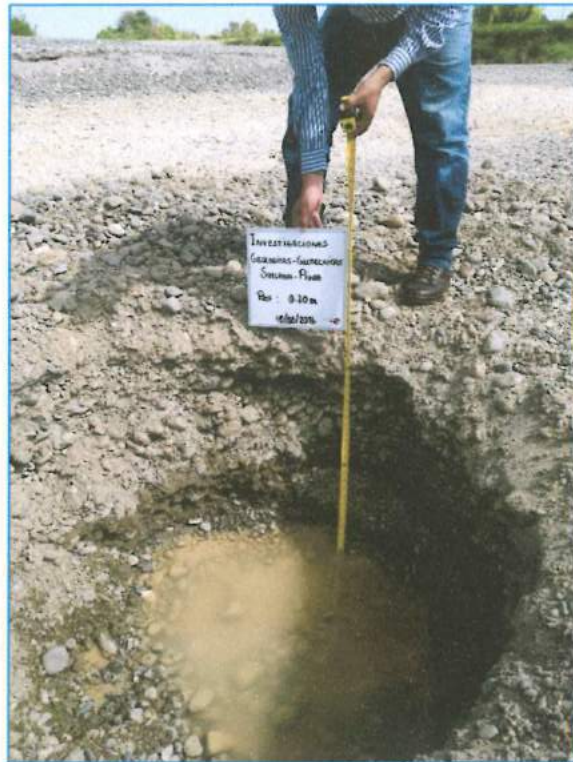
Figura 20.- Calicata CRCH-02 Depósito de Gravas arenosas con nivel freático somero.
