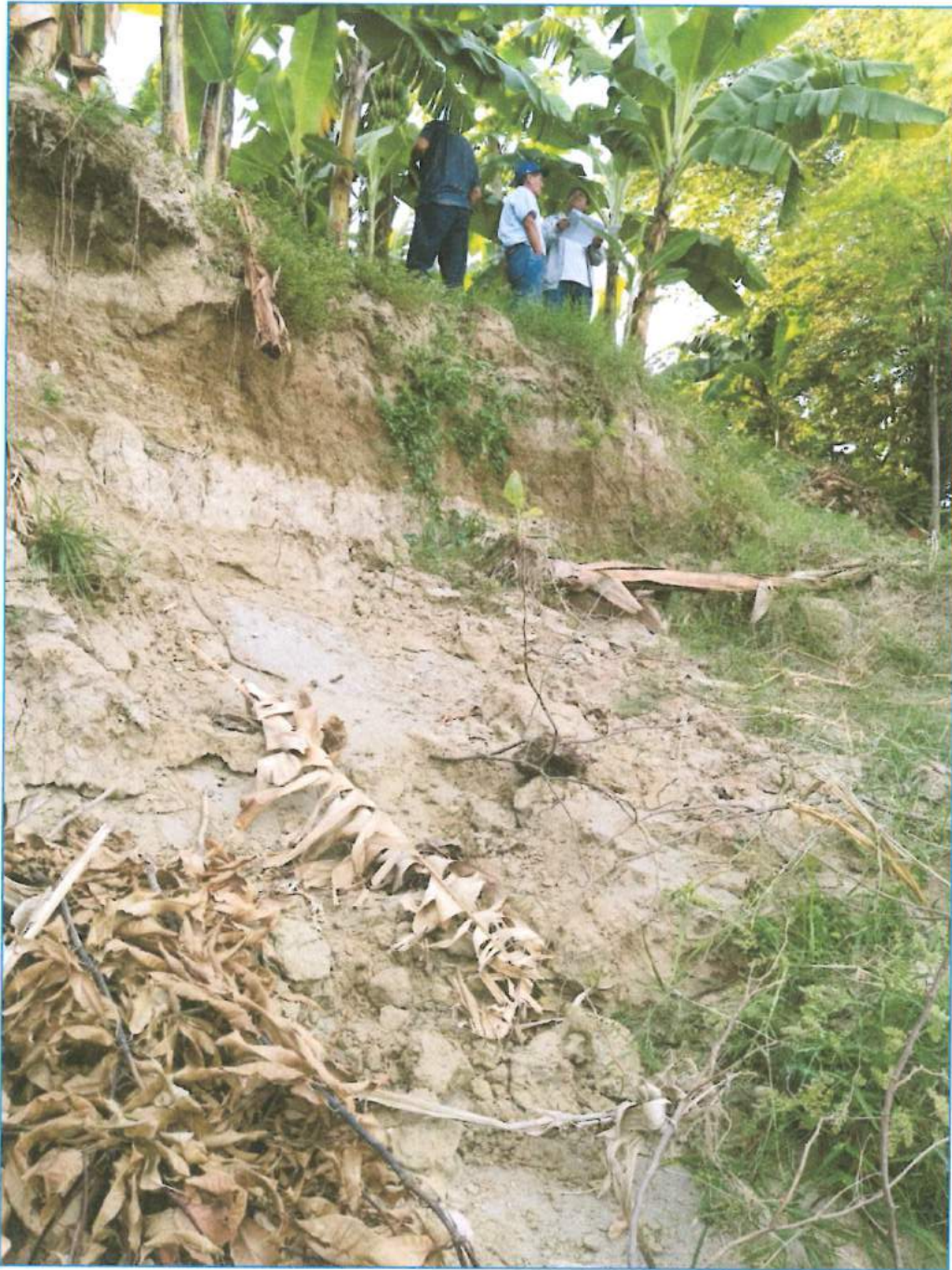
Figura 06.- Sector del río en donde se observa la terraza alta con fuerte erosión ribereña que la ha escarpado. Se puede observar que esta está compuesta de suelos finos limo arcilloso de color gris claro a beige. Esta toma está localizada en la margen derecha y aguas abajo del curso del río, a la altura de la calicata CRCH-02
