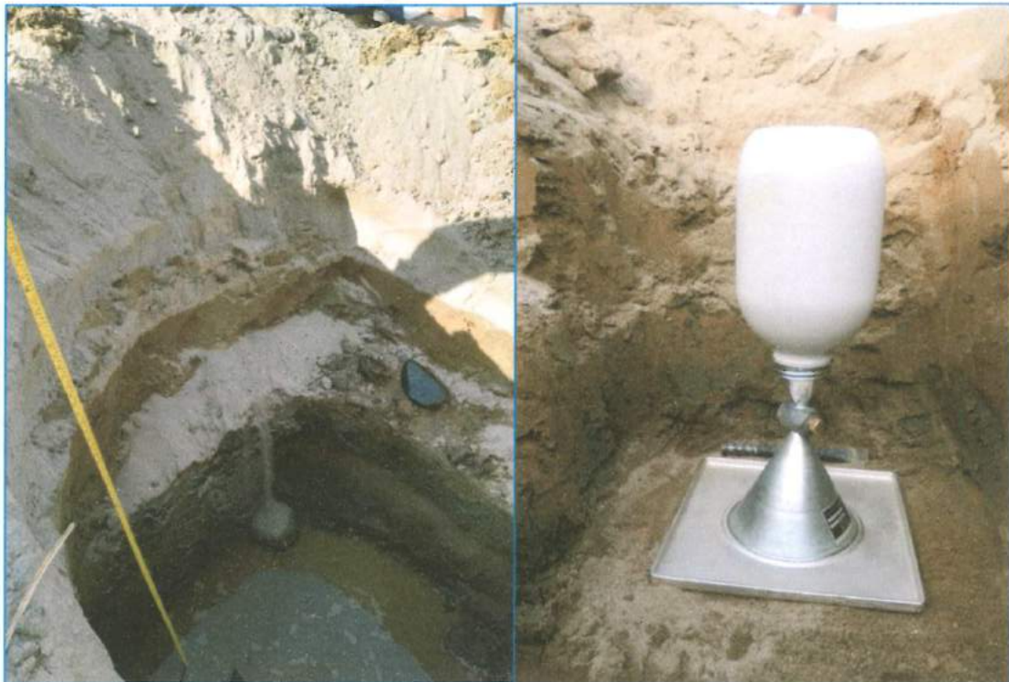
Figura 25.- Calicata CRCH-04 Hacia la base se observa arena gravosa.
