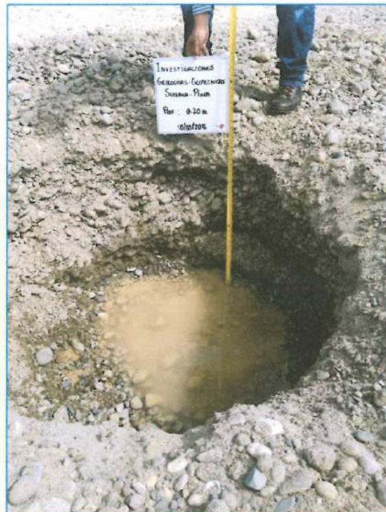
Figura 21.- Calicata CRCH-02. Depósito de gravas. NF somero.
