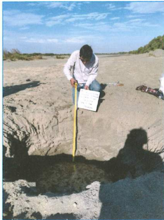
Figura 30.- Calicata CRCH-07 Arena fina.
