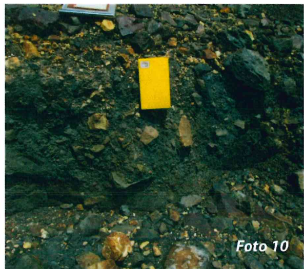
Foto 7: Pista destruida en marzo del 2014 Foto 8: Salto de aproximadamente 40 cm originado por una grieta Foto 9: Grieta de aproximadamente 20 cm de apertura Foto 10: Fragmentos angulosos a subangulosos envueltos en una matriz limo arcillosa.
