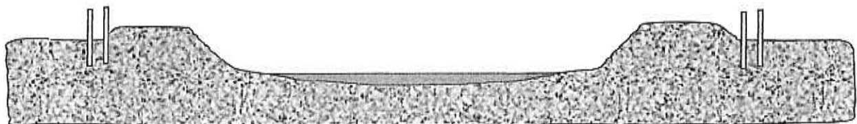
FORMACIÓN DE DIQUE CON MATERIAL PROPIO
