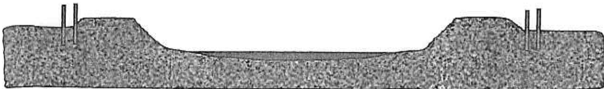
FORMACIÓN DE DIQUE CON MATERIAL PROPIO
