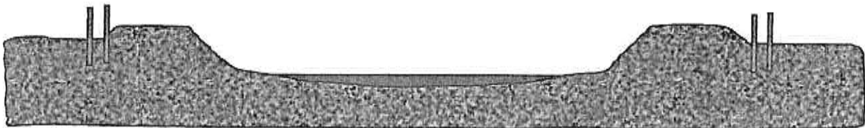
FORMACIÓN DE DIQUE CON MATERIAL PROPIO
