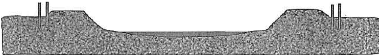
FORMACIÓN DE DIQUE CON MATERIAL PROPIO
