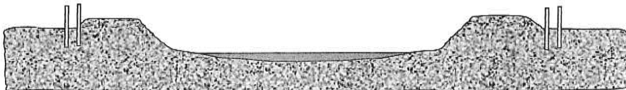
FORMACIÓN DE DIQUE CON MATERIAL PROPIO
