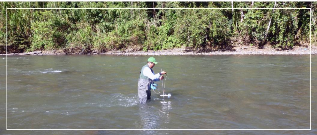
FOTO N° 16: Aforo con correntímetro del río San Juan de Loro.
