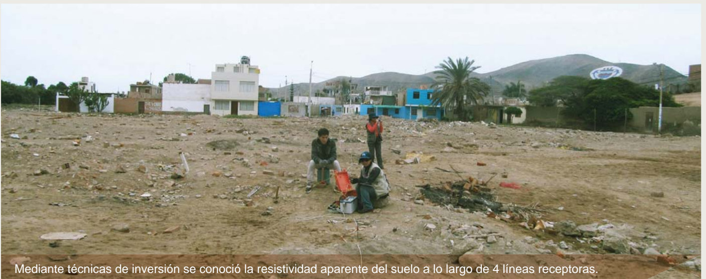
Para su registro las ondas Rayleigh son producidas artificialmente con una comba.
