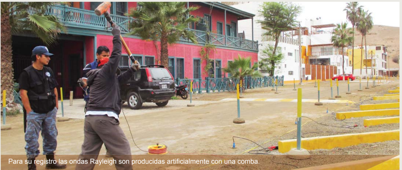
Se realizó el registro de vibración ambiental en 110 puntos de la área urbana de Cerro Azul.
