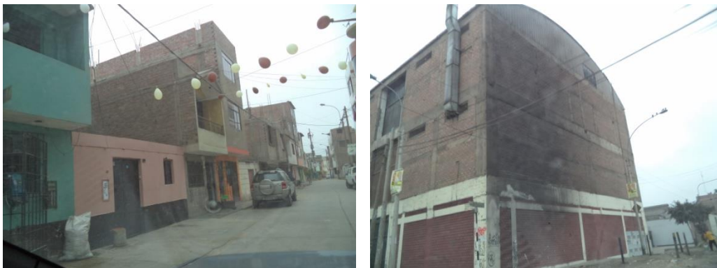
Figura 13. Viviendas construidas con ladrillo artesanal sólido y edificaciones industriales construidas con ladrillo industrial sólido.
