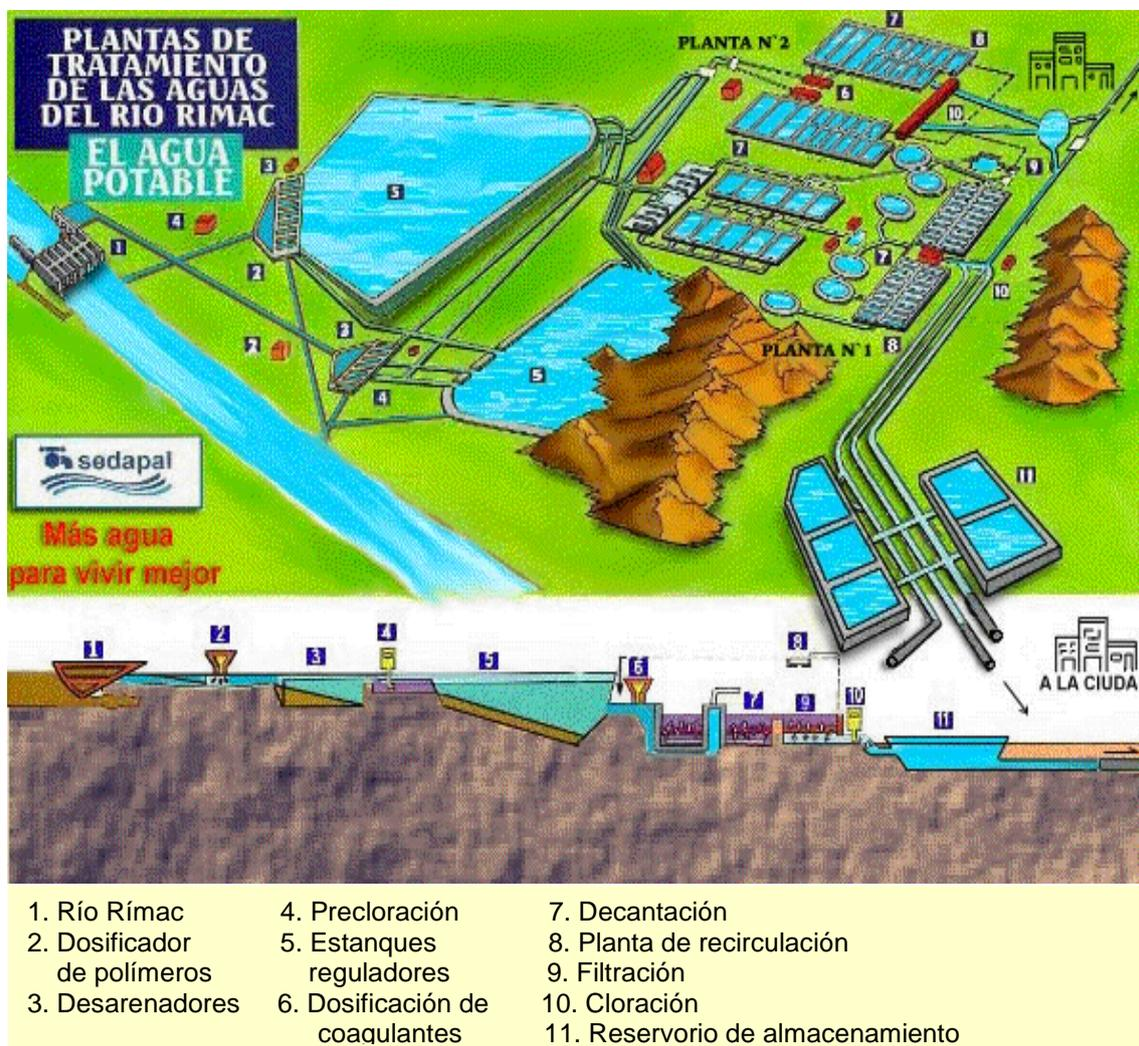
Figura 46. Esquema de la planta de tratamiento de la Atarjea
