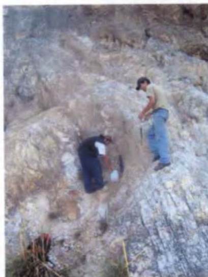
Prueba de infiltración en la formación Chimú
