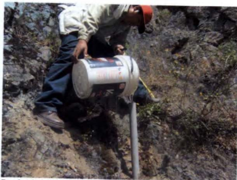
Prueba de infiltración en la formación Chimú
