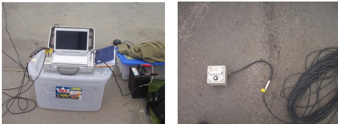
Figura 7.3. Equipo de adquisición de datos GEODAS 15 HS (izq.) y sensor de 1 HZ de frecuencia tipo CR4.5-1S (der).
